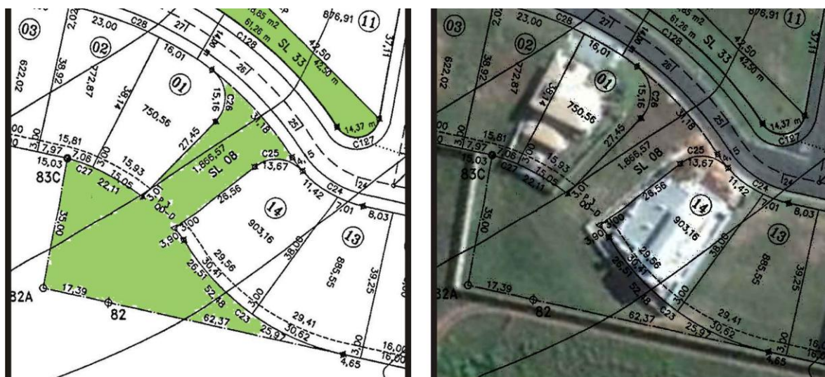
Figura 40 – Esquerda: Trecho do projeto aprovado com demarcação do SL08. Direita: Trecho do projeto aprovado sobreposto à foto aérea. A real função da praça em questão é a divisão da quadra perimetral do fechamento, visando não infringir a legislação municipal. Fonte: Seplama/Google Earth(2010).
