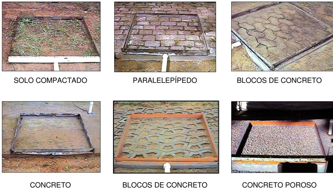
**Figura 15** – Modelos de pavimentos porosos. Tucci: 2005.
