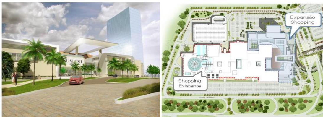
O projeto de expansão do Iguatemi Campinas consiste em utilizar uma área do estacionamento externo e uma parte do existente, para a construção de 3 pavimentos de shopping e 3 subsolos de estacionamento.
