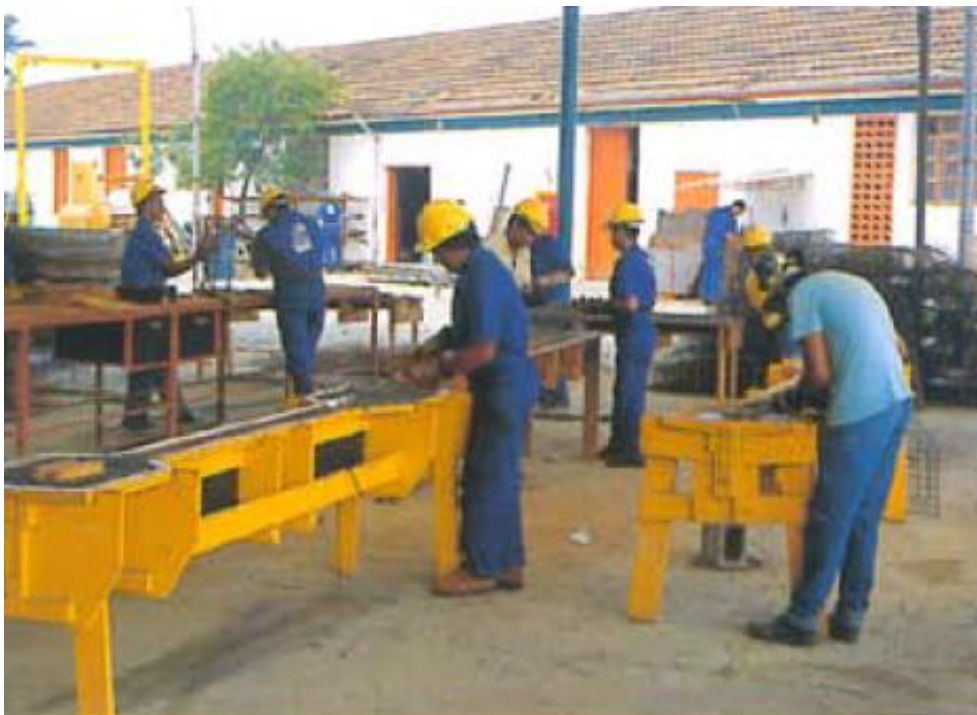
Figura 24 - Gabarito de madeira para armação das peças. Fonte: CAMPOS, 1994, p.17.
