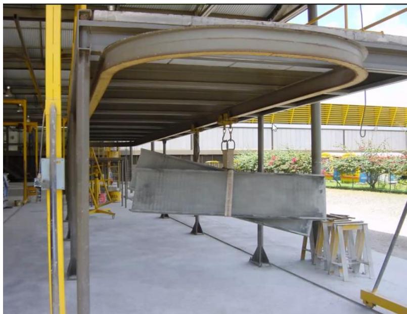
Figura 57 - Movimentação através de monovia das peças no setor de acabamentos. Fonte: Arquivo CTRS.
