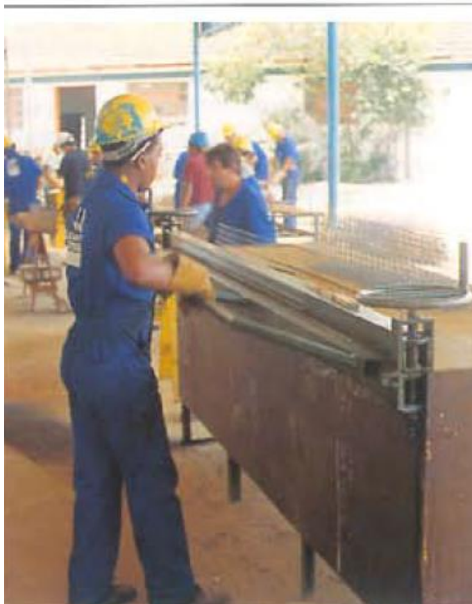
Figura 23 - Mesa dobradeira manual de tela. Fonte: CAMPOS,1994, p.18.
