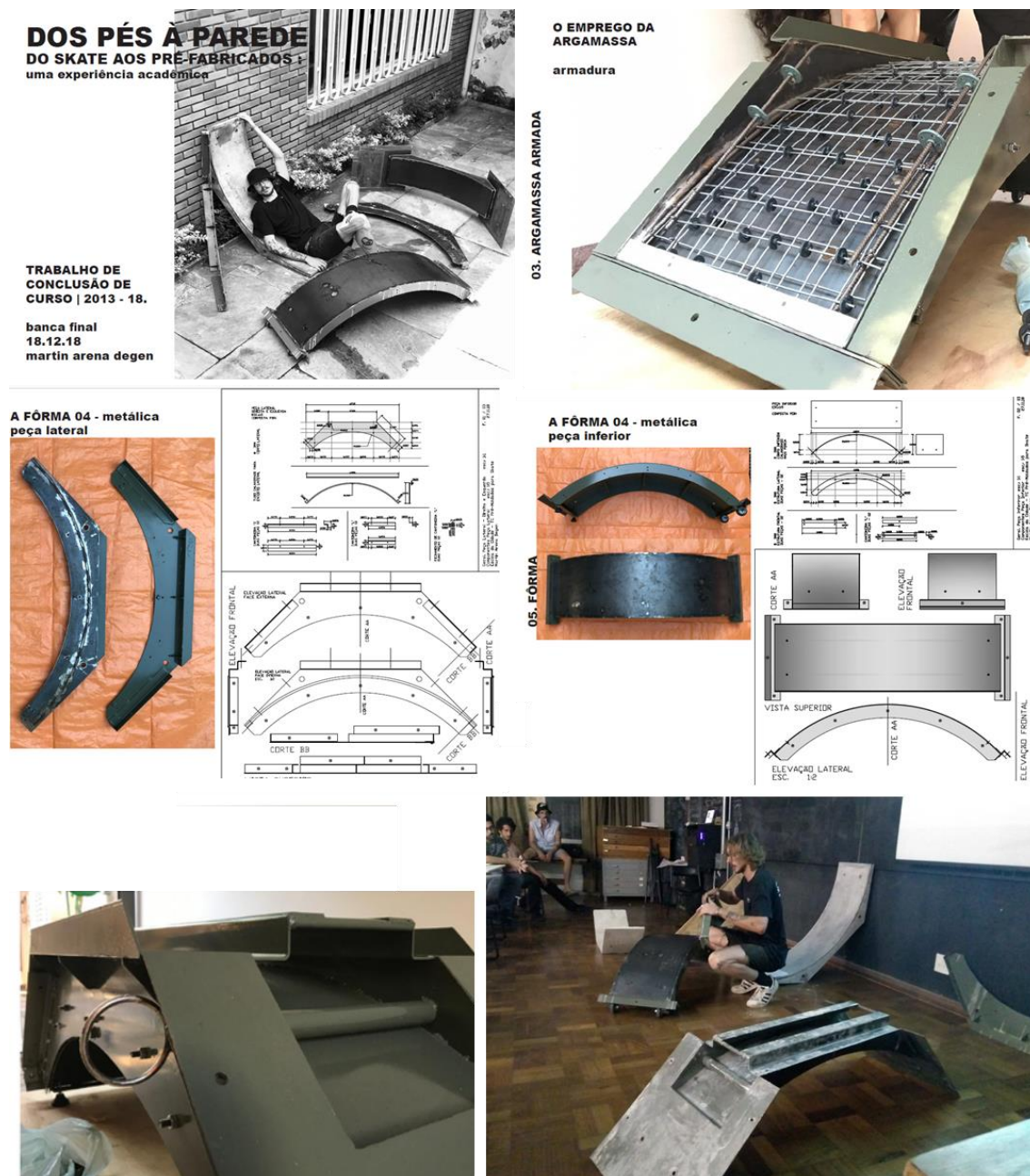
Figura 105 – Rampa de skate. Na sequência da esquerda para a direita e cima para baixo: peça realizada com formas, detalhe da armação na forma, desenhos e peças executadas das formas metálicas, detalhe da forma metálica, apresentação do trabalho na faculdade. Fonte: imagens realizadas pelo autor.
