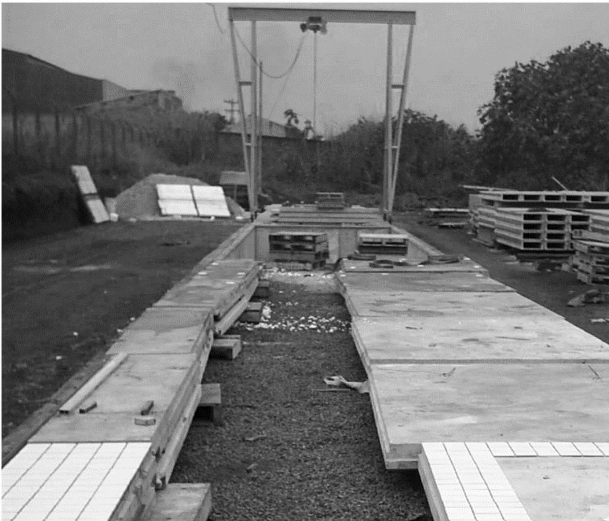
Figura 89 – Elemento de vedação em argamassa armada com camada interna em EPS para isolamento, recebendo revestimento cerâmico e rejunte para posterior envio a locais de montagem em obra. Foi utilizado em edificação de 8 pavimentos.
