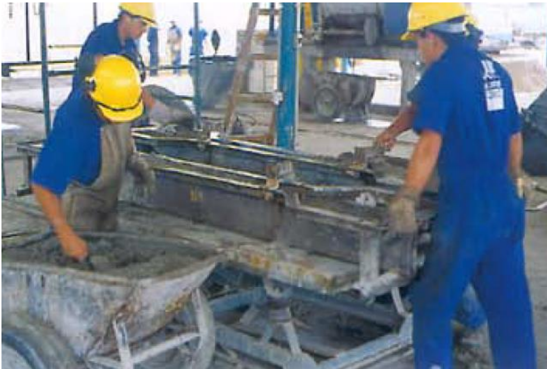
Figura 20 - Fundição de peças em formas móveis sobre mesa vibratória. Fonte: CAMPOS, 1994, p.20.
