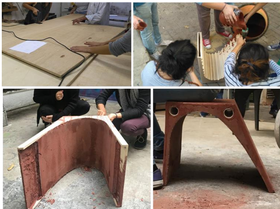
Figura 102 – Banco de mobiliário urbano em argamassa armada pigmentada. Na sequência da esquerda para a direita e cima para baixo: corte de forma, fundição com hiperplastificante, peça desformada e peça em teste de uso. Fonte: imagens realizadas pelo autor.
