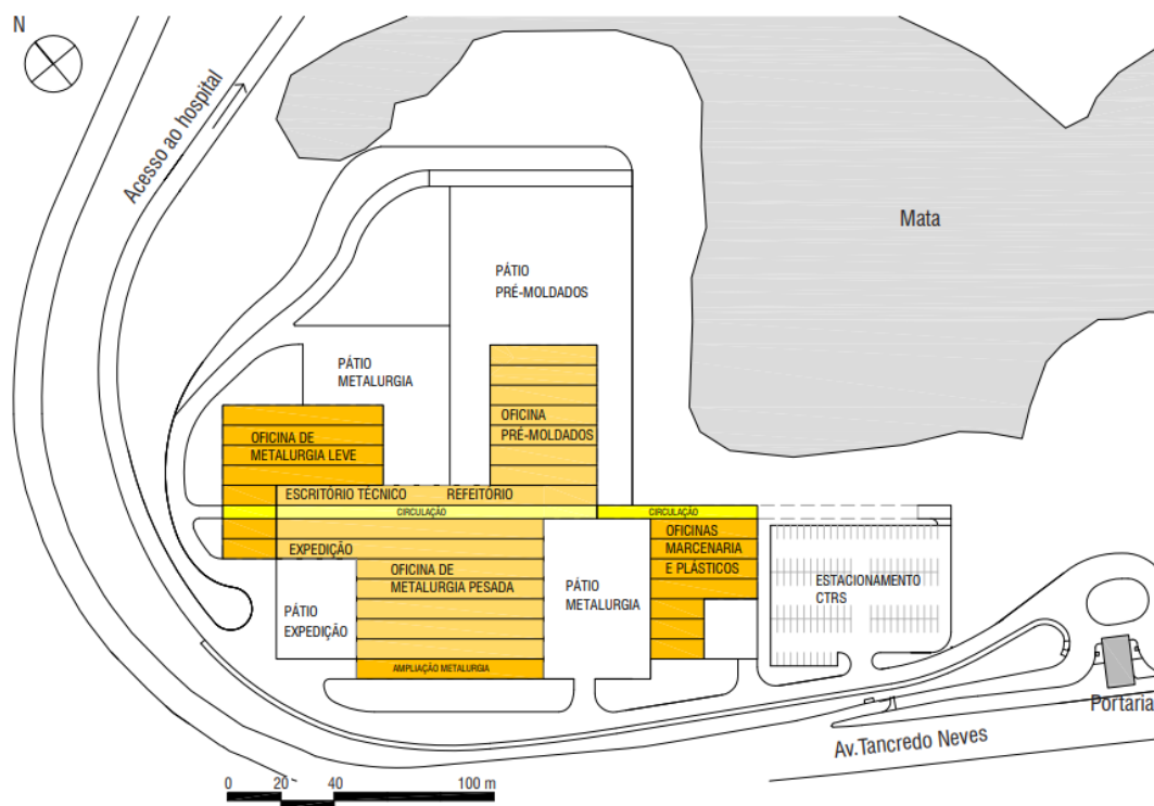
Figura 58 - Esquema de implantação da fábrica do CTRS. Fonte: Mosaner (2021).
