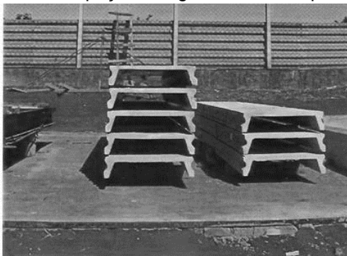
Figura 87: Etapas do processo de fundição de laje em argamassa armada sobre mesa vibratória. Fonte: peça e imagem realizadas pelo autor.
