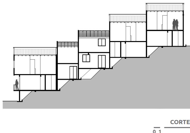
Figura 82 – Comuna Don Helder Câmara, corte de implantação das habitações em desnível. Fonte: VILAÇA, 2015, p. 333.
