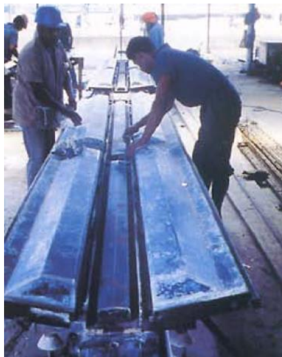
Figura 32 - Limpeza e aplicação de desmoldante em forma metálica. Fonte: CAMPOS,1994, p.18.
