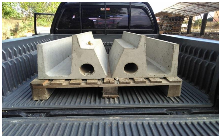
Figura 97 – Peça de função híbrida: coletora de águas pluviais e berço de recepção e transferência de cargas de laje de piso e vedação externa. C=1m; peso=80kg. Peça moldada sendo transportada em caminhonete. Fonte: peça e imagem realizadas pelo autor.
