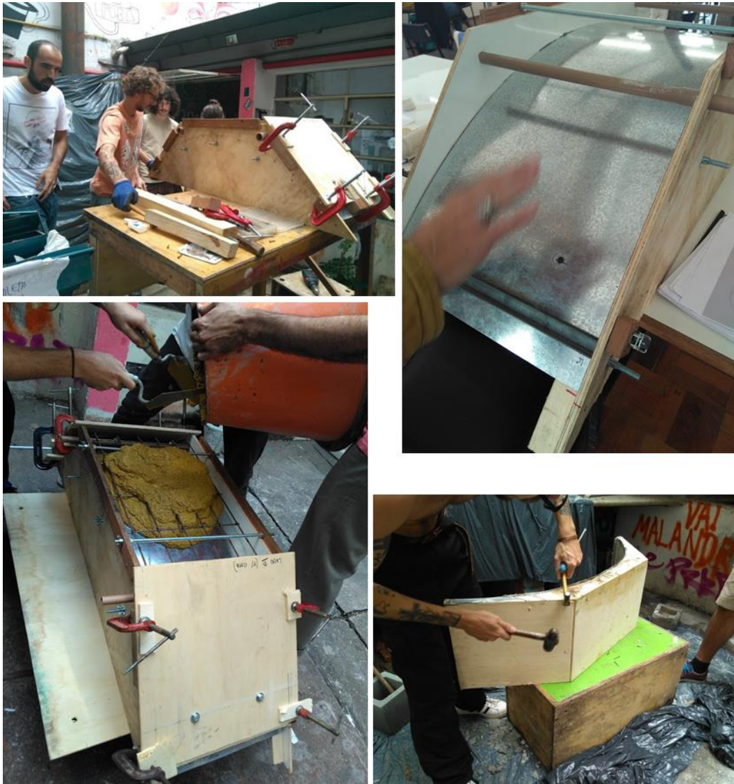
Figura 103 – Rampa de skate. Na sequência da esquerda para a direita e cima para baixo: montagem da forma e forma, forma pronta, fundição e desforma. Fonte: imagens realizadas pelo autor.
