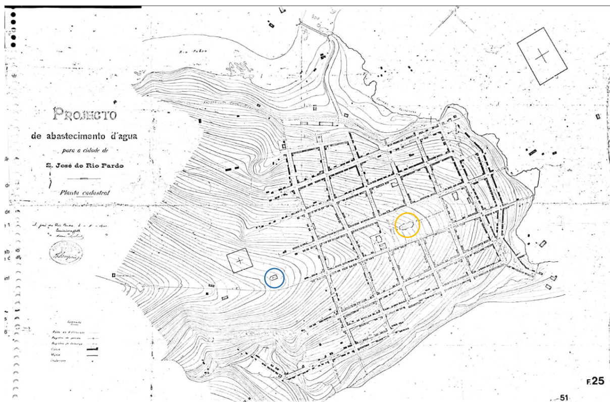
Figura 62 – Planta do Projeto de abastecimento d'água para a cidade de São José do Rio Pardo, assinada pelo Eng. Teodoro Sampaio. Em amarelo, destaca-se a Igreja Matriz e, em azul, a capela do Rosário. FONTE: Menechino (1986).
