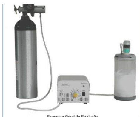
Figura 4. Sistema de gás ozonizado completo
