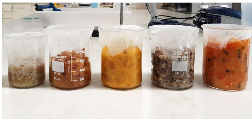
Figura 5. Resíduos de batata, maçã, manga, inhame e mamão com o tamanho de partícula reduzido.
