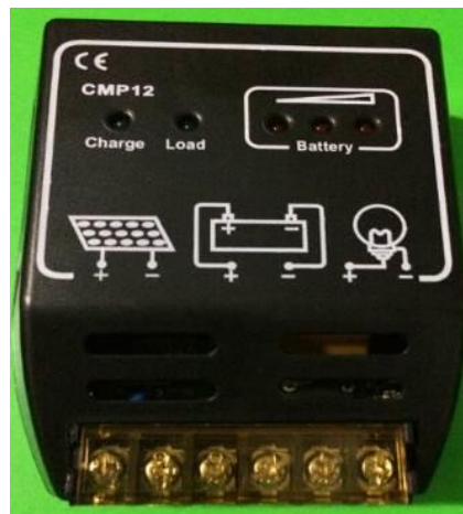
Figura 8 – Controlador de Carga Fonte: Elaborada pelo autor
