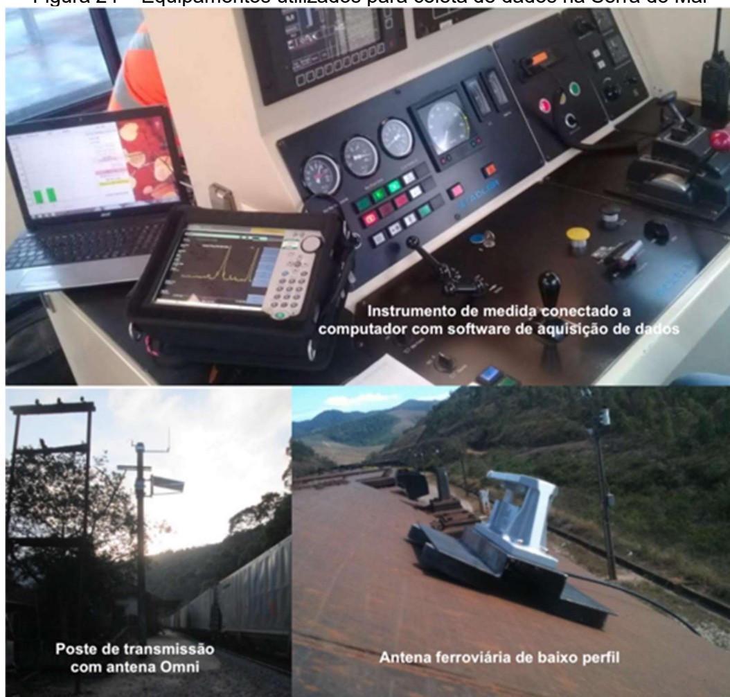
Figura 24 – Equipamentos utilizados para coleta de dados na Serra do Mar
