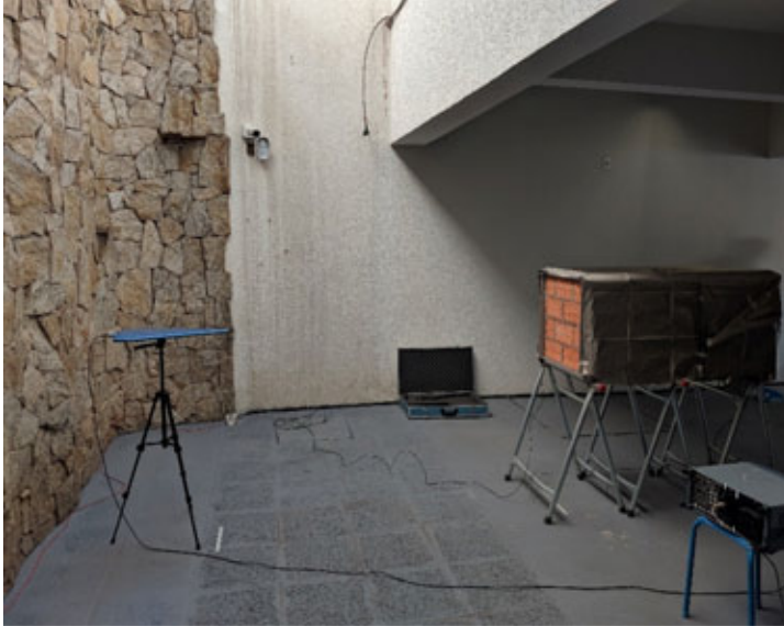
Figura 35. Medição de parede de tijolos cerâmicos de 6 furos.
