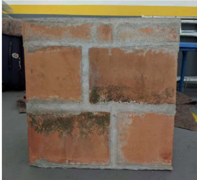
Figura 26. Parede de blocos cerâmicos estrutural de 14 cm
