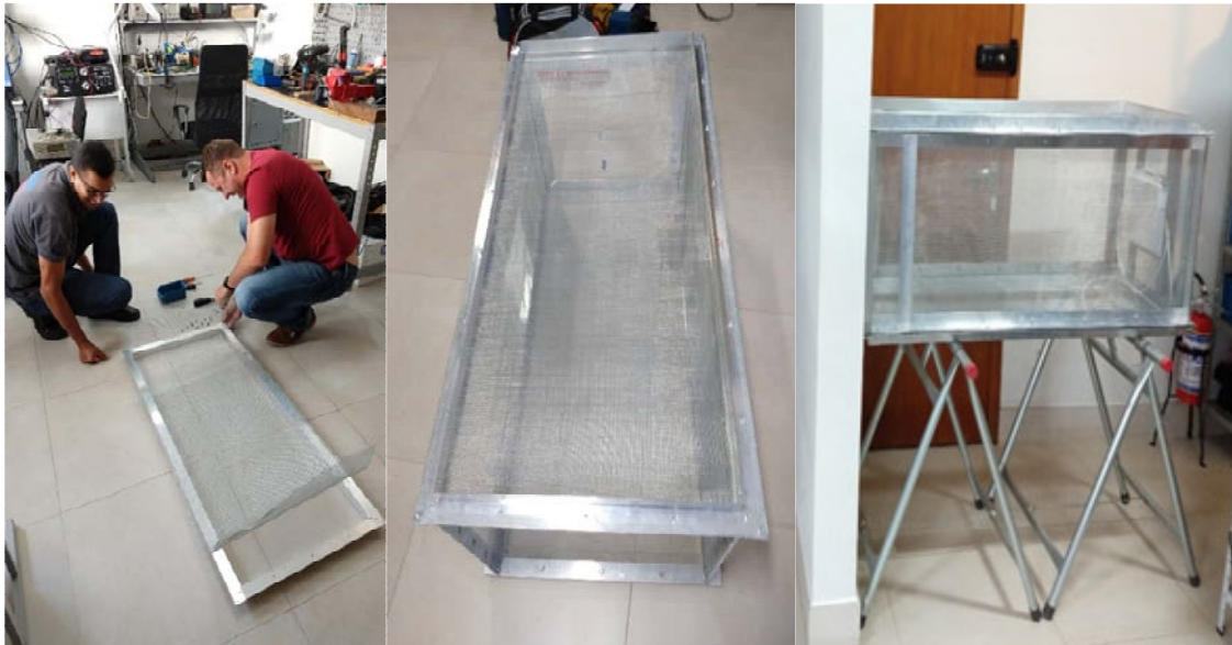
Figura 31. Processo de construção da câmara de teste.
