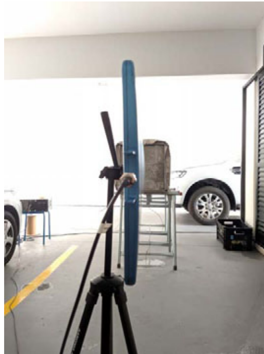
Figura 42. Medição de parede blocos de concreto semi-estrutural de 14 cm.
