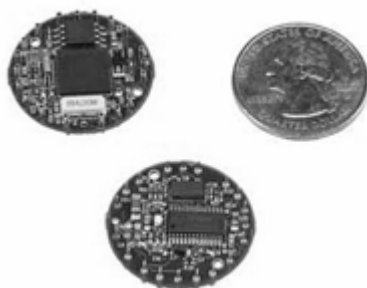
Figura 3. Exemplo da miniaturização como no sensor Mica2DOT2.
