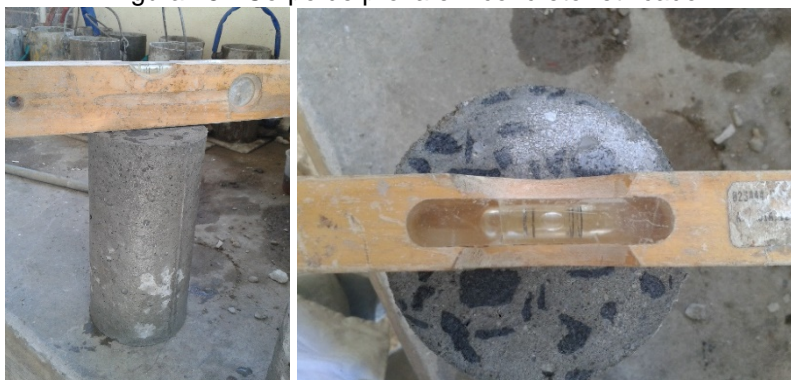
Figura 25 - Corpo de prova em concreto retificado
