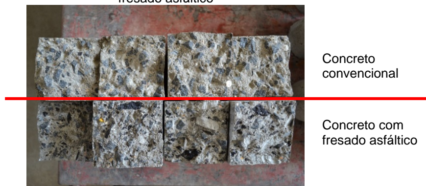
Figura 53 - Comparativo de corpos de prova prismáticos com concreto convencional e com fresado asfáltico
