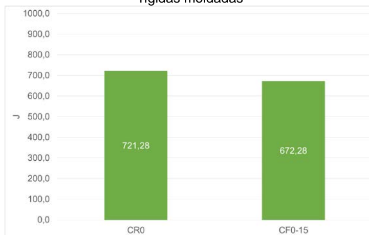
Gráfico 21 - Comparativo da média dos resultados do ensaio ao impacto adaptado nas barreiras rígidas moldadas
