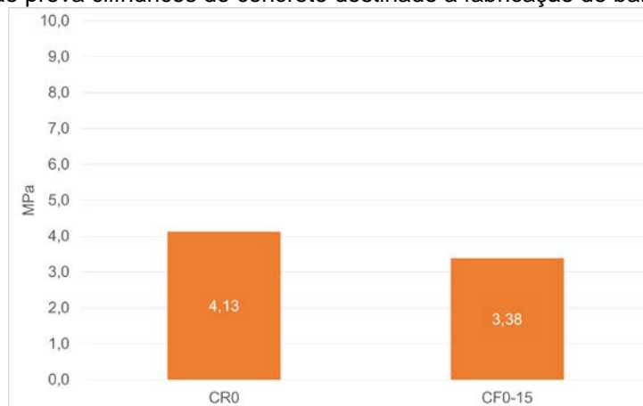
Gráfico 18 - Comparativo de resultados de resistência média à tração por compressão diametral de corpos de prova cilíndricos do concreto destinado a fabricação de barreiras rígidas
