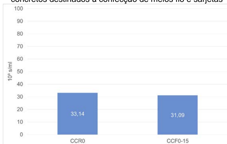
Gráfico 37 - Comparativo dos valores de WAR para determinação da permeabilidade a água dos concretos destinados à confecção de meios fio e sarjetas
