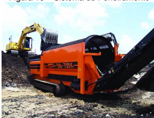
Figura 13 – Sistema de Peneiramento
