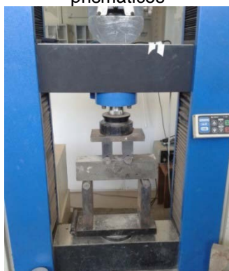
Figura 30 - Ensaio de determinação da resistência à tração na flexão de corpos de prova prismáticos
