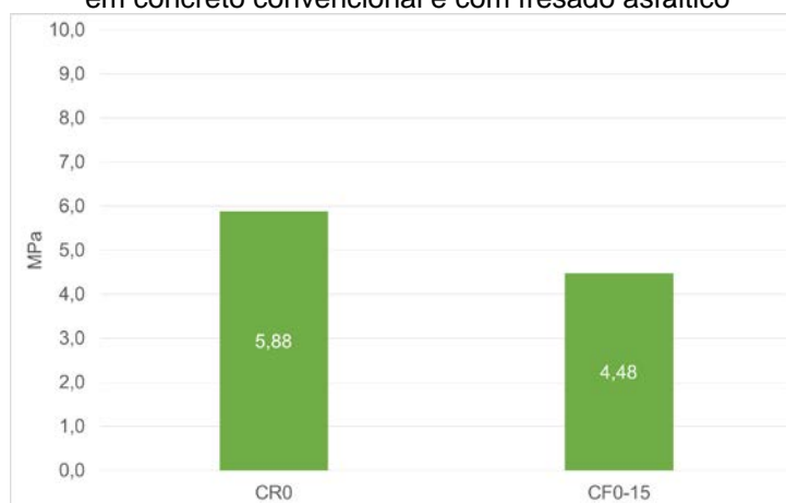
Gráfico 20 - Comparativo de resistência à tração média na flexão de corpos de prova prismáticos em concreto convencional e com fresado asfáltico
