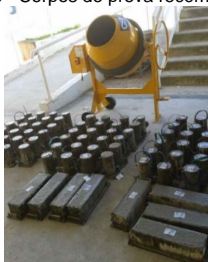
Figura 23 - Corpos de prova recém moldados
