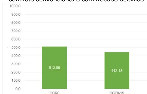
Gráfico 32 - Comparativos de resultados do ensaio de impacto nos meios fio e sarjetas em concreto convencional e com fresado asfáltico
