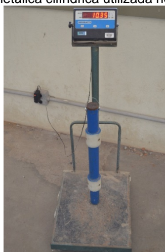
Figura 41 - Peça metálica cilíndrica utilizada no ensaio de impacto
