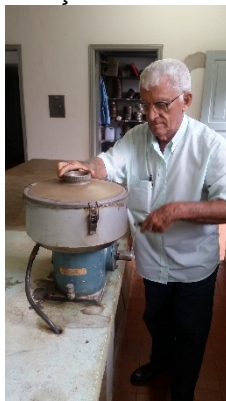
Figura 39 – Ensaio de determinação de teor de betume no fresado asfáltico
