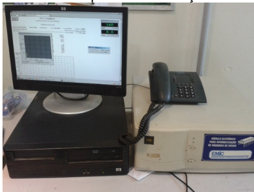
Figura 27 – Módulo eletrônico para informatização de máquinas de ensaio
