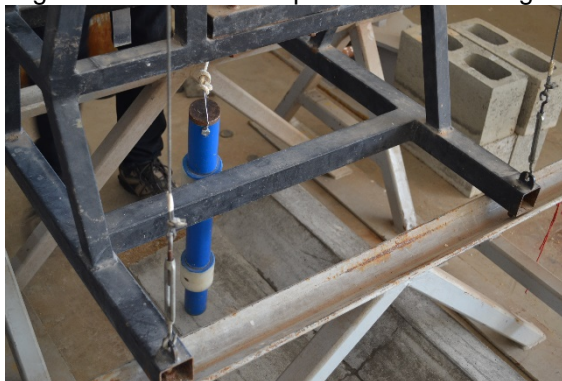
Figura 43- Ensaio ao impacto da barreira rígida
