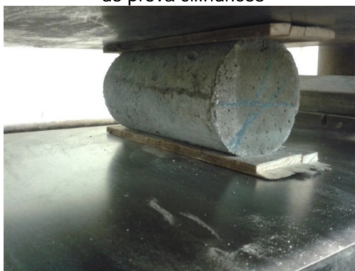
Figura 28 - Ensaio de determinação da resistência à tração por compressão diametral de corpos de prova cilíndricos
