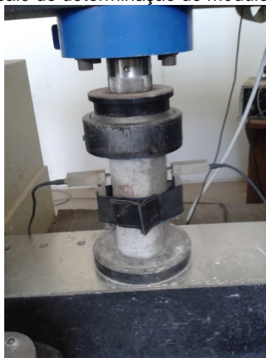
Figura 29 - Ensaio de determinação do módulo de elasticidade
