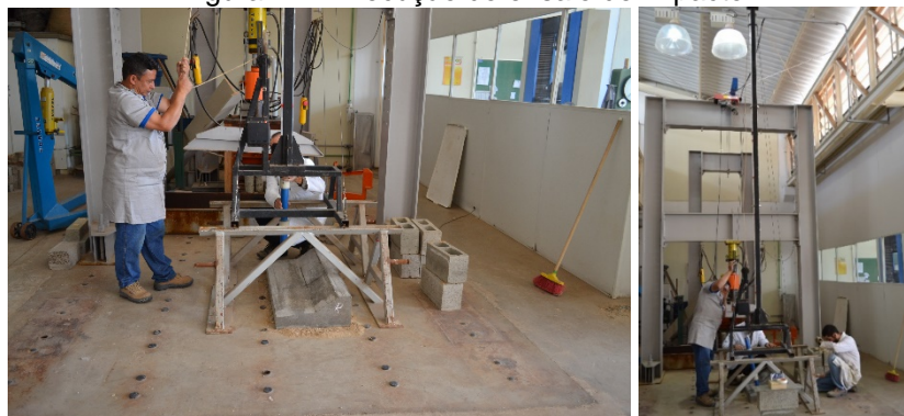
Figura 44 - Execução do ensaio de impacto
