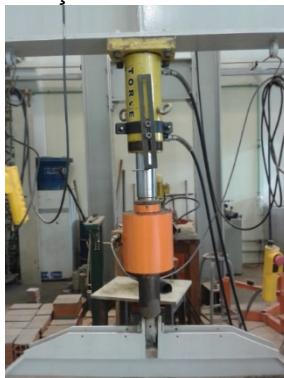
Figura 32 – Equipamento de realização de ensaio a flexão com pistão hidráulico Torvel
