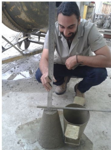
Figura 40 - Ensaio de abatimento com o tronco de cone
