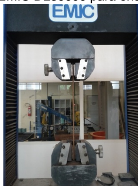
Figura 22 - Prensa EMIC DL30000 para ensaio de barras de aço
