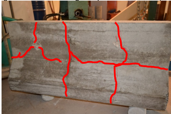
Figura 42 - Barreira rígida após ensaio de impacto
