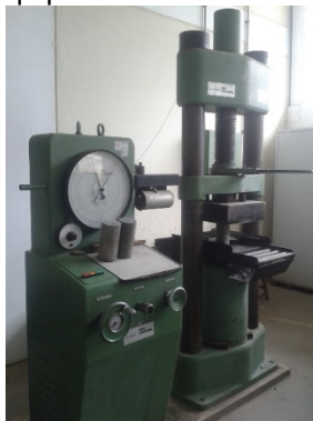
Figura 26 - Equipamento de ensaio à compressão
