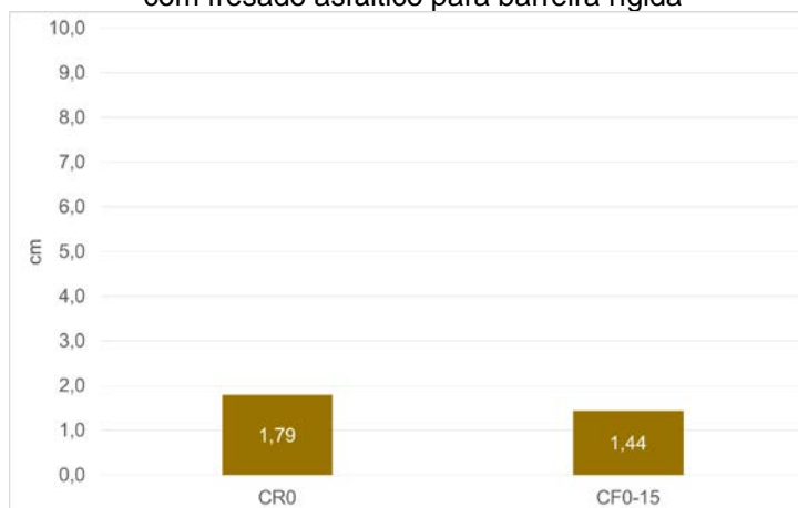
Gráfico 23 - Comparativo da ascensão capilar média no corpo de prova de concreto convencional com fresado asfáltico para barreira rígida
