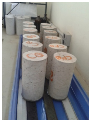
Figura 45 - Ensaio de absorção de água por capilaridade dos concretos convencional e com fresado asfáltico destinados a barreiras rígidas
