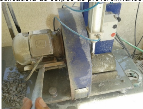
Figura 24- Retificadora de corpos de prova cilíndricos em concreto
