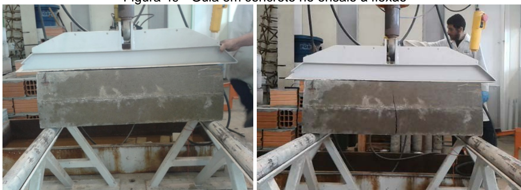
Figura 49 - Guia em concreto no ensaio à flexão
