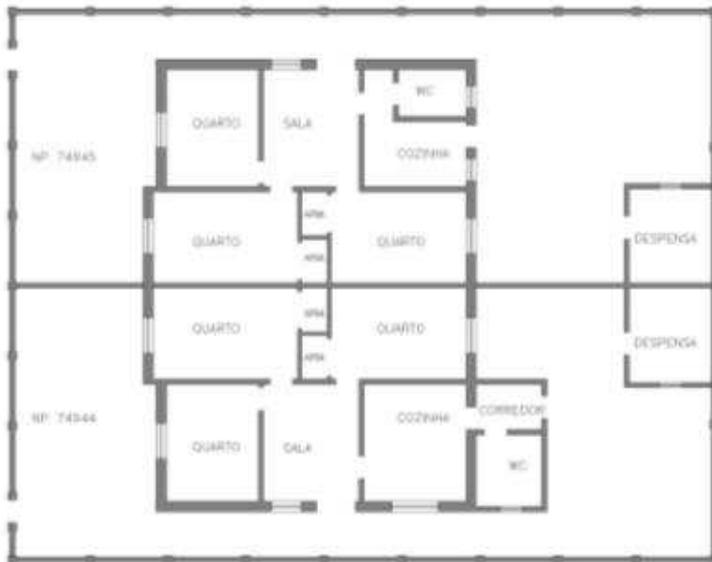
Figura 12 - Planta de residência geminada pertencente ao segundo conjunto.
