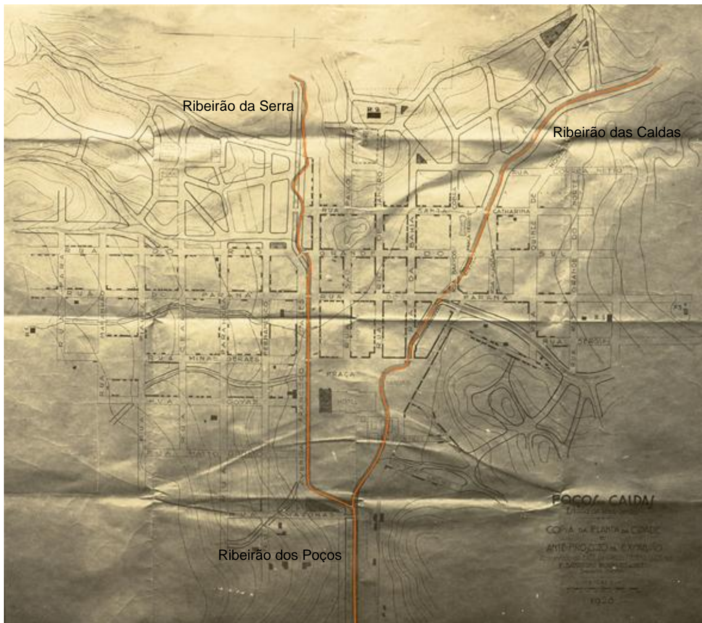
Figura 2.43: Anteprojeto de Expansão de Saturnino de Brito para a cidade em 1928. Retificação dos Ribeirões: da Serra, das Caldas e dos Poços. Fonte: Museu Histórico Geográfico de Poços de Caldas.
