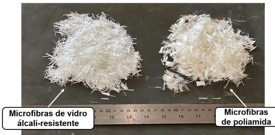
Figura 18: Ilustração das microfibras de polipropileno e poliamida avaliadas neste estudo
