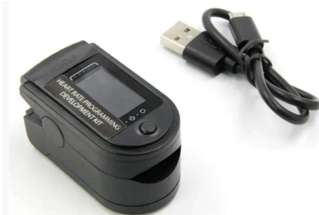
Figura 19. Kit de desenvolvimento de oxímetro TTGO.
