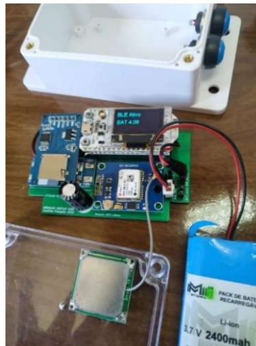
Figura 26 - PCI montada com os módulos
