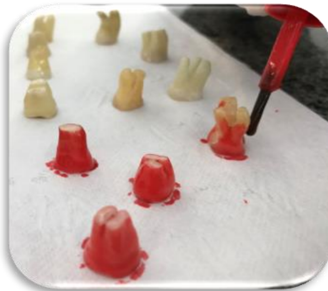
Figura 1. Impermeabilização das amostras com resina epóxi e esmalte cosmético para unhas.
