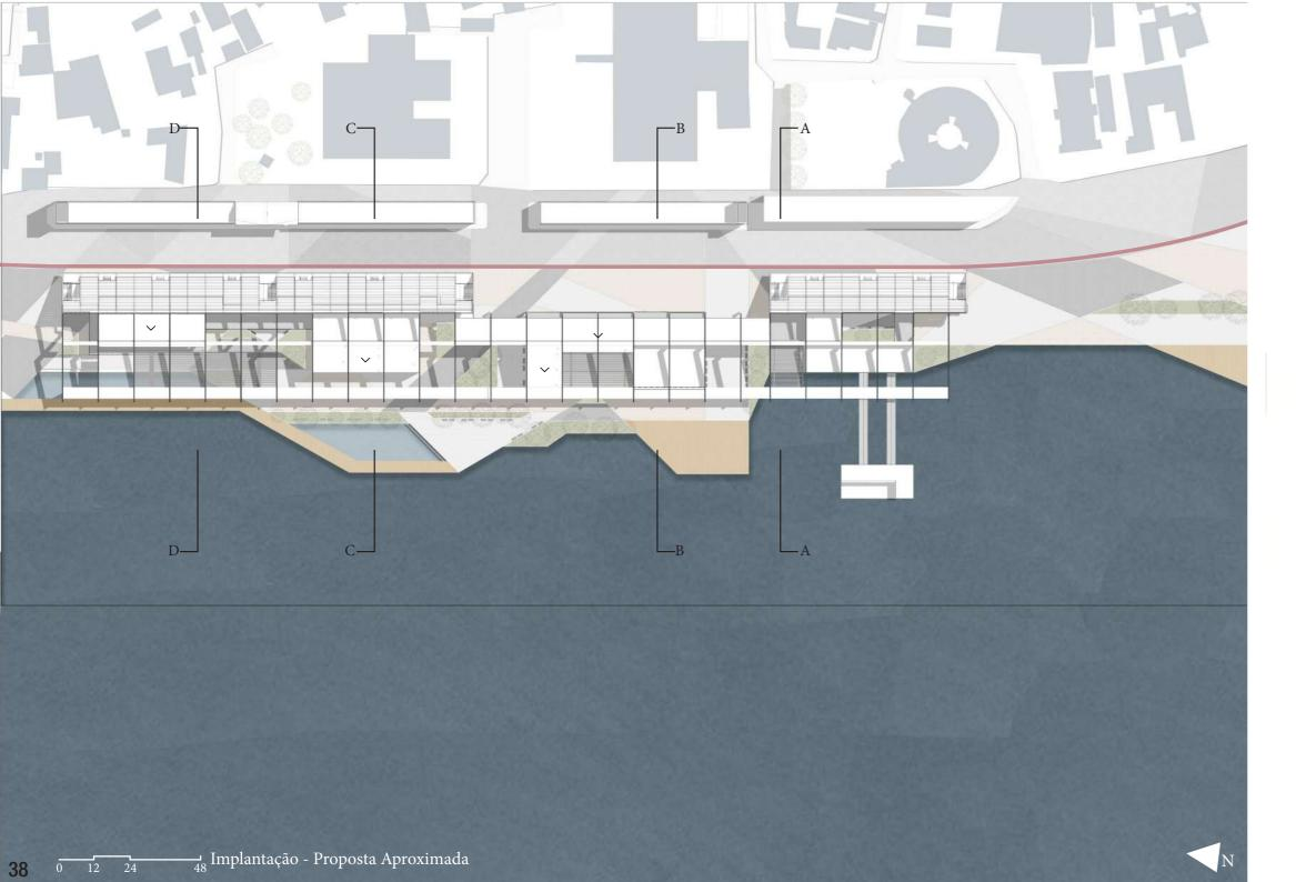
A nova estrutura do Sambódromo avança em torno de 35 metros a partir da viga superior das arquibancadas existentes. Essa nova estrutura se dá na forma de um pórtico em concreto com 20 metros de extensão, com vigas laterais e tirantes que conectam-se com a estrutura da arquibancada existente.
