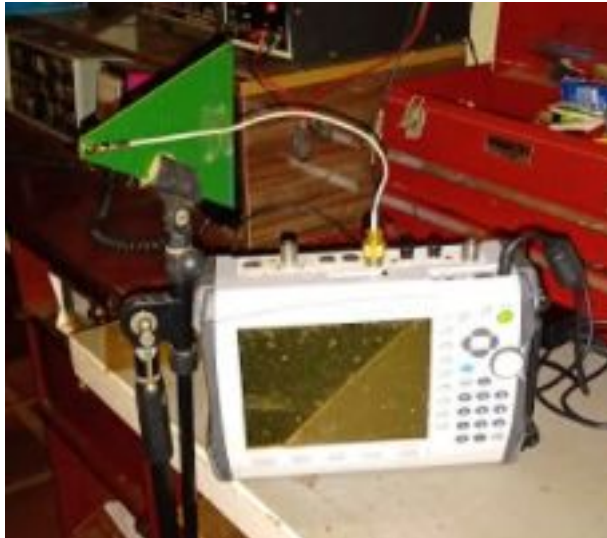
Imagem 01 - Setup de caracterização da antena.
