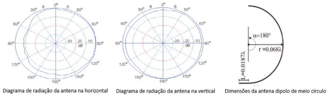
Figura 06 - Dimensões e diagrama de radiação da antenna dipolo.
