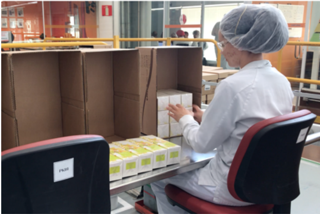
Figura 37 – Processo Realizado de Forma Manual – Encaixotar Produto
