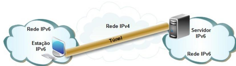
**Figura 6. Túnel dispositivo final para dispositivo final**
