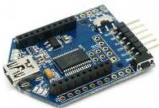
**Figura 5. Base para módulo RFBee [6]**
