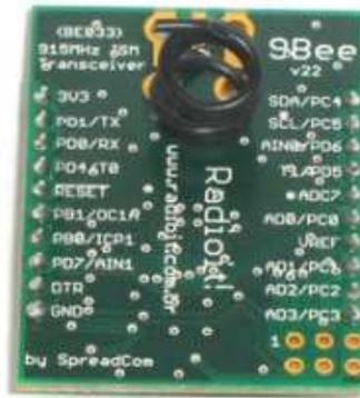
Figura 3 – Módulo BE 900 (RADIOIT, 2012)
