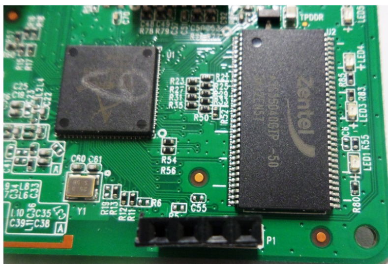
Figura14: PCB do TL-MR3020 após modificação na serial.
