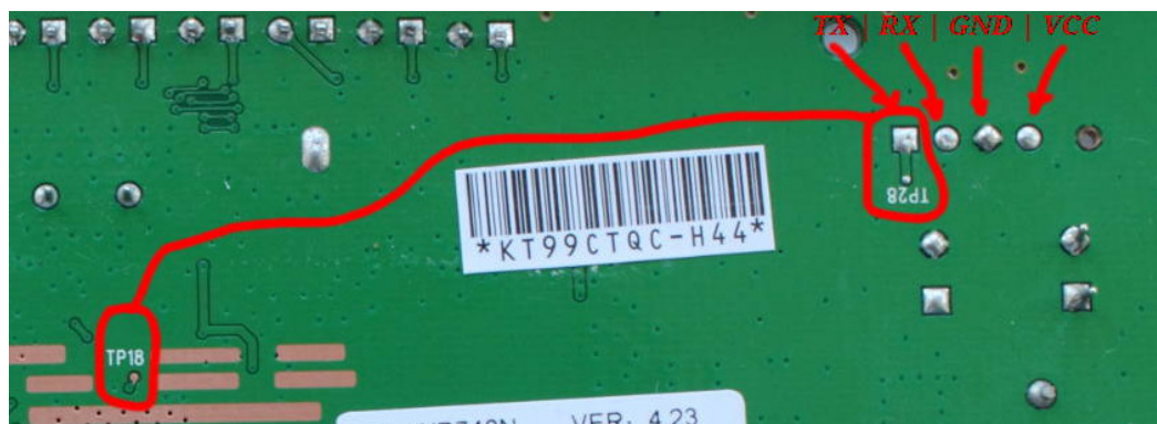
Figura11: Modificação de Hardware : Conexão entre dois pontos para funcionamento do TX [17].
