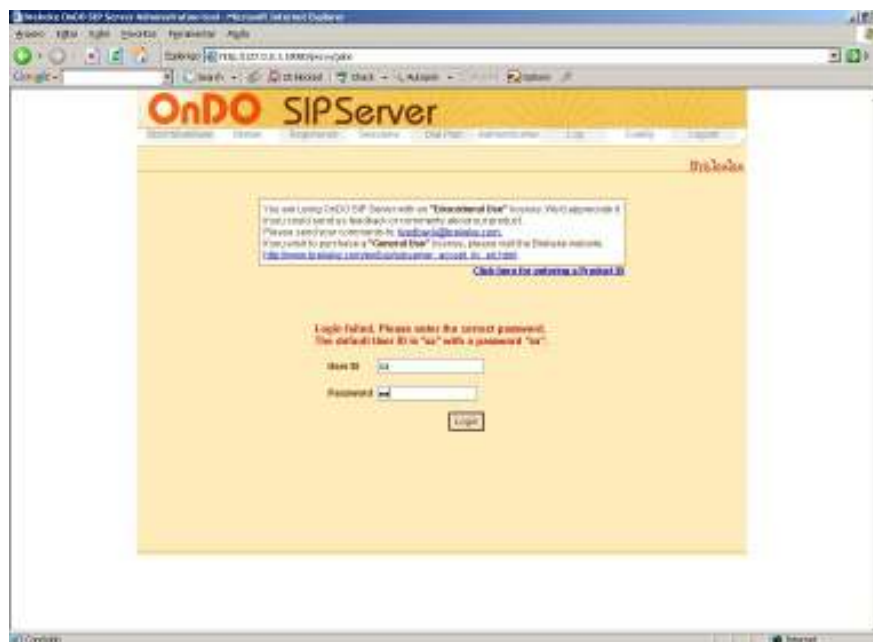
Figura 2: O usuário e a senha para a administração do sistema, por default = sa
