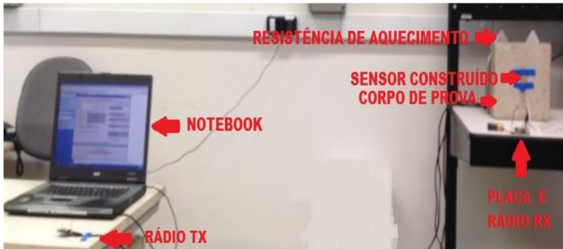
Figura 52 - Bancada montada para o teste de aquecimento do corpo de prova com o sensor de temperatura de superfície.
