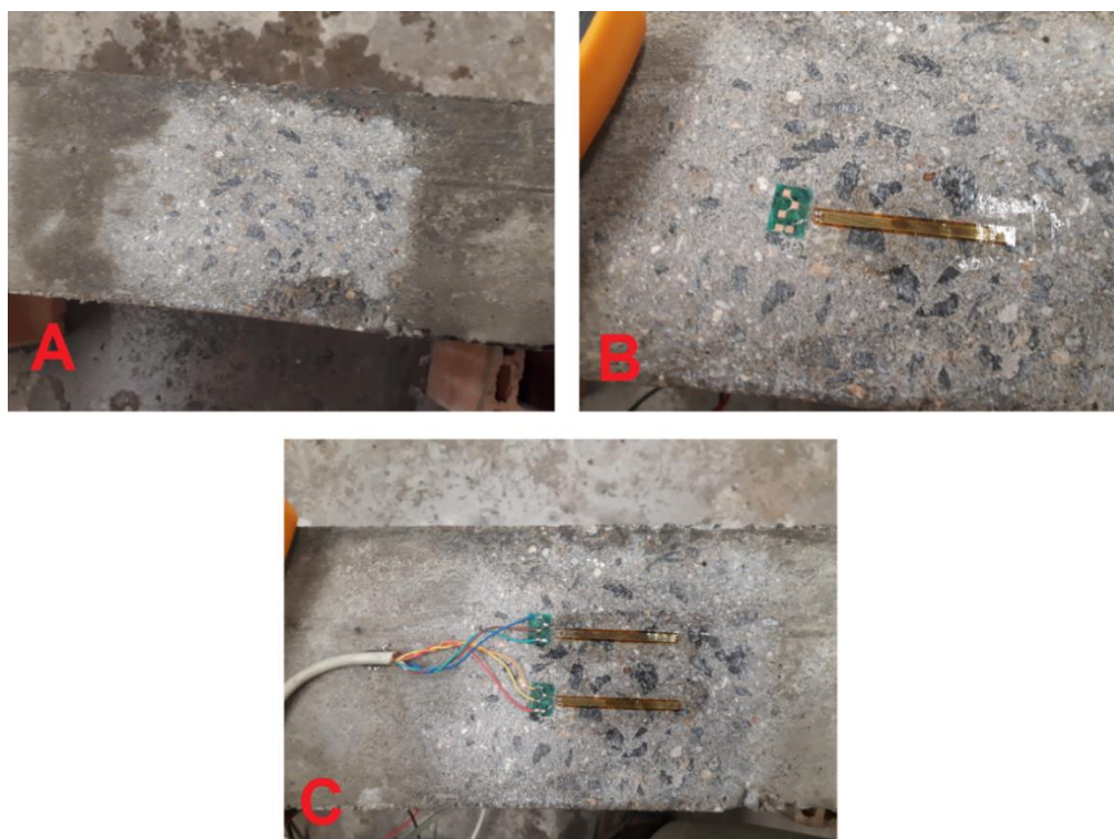
Figura 99. A) Preparo da superfície; B) Colagem do extensômetro e terminal; C) Conexão dos cabos dos extensômetros E1 e E2
