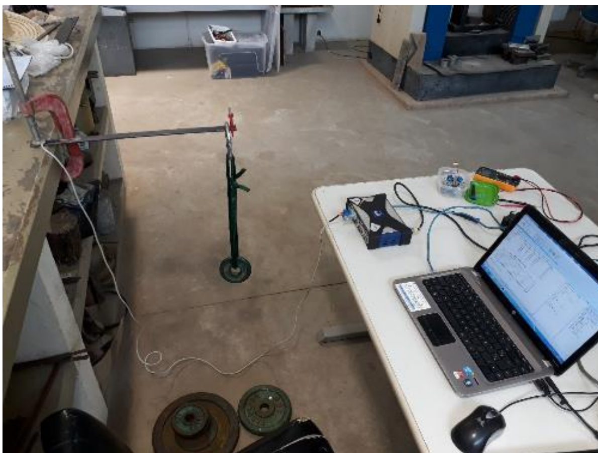
Figura 106. Ensaio de Lâmina n.º 1 sob flexão com QuantumX
