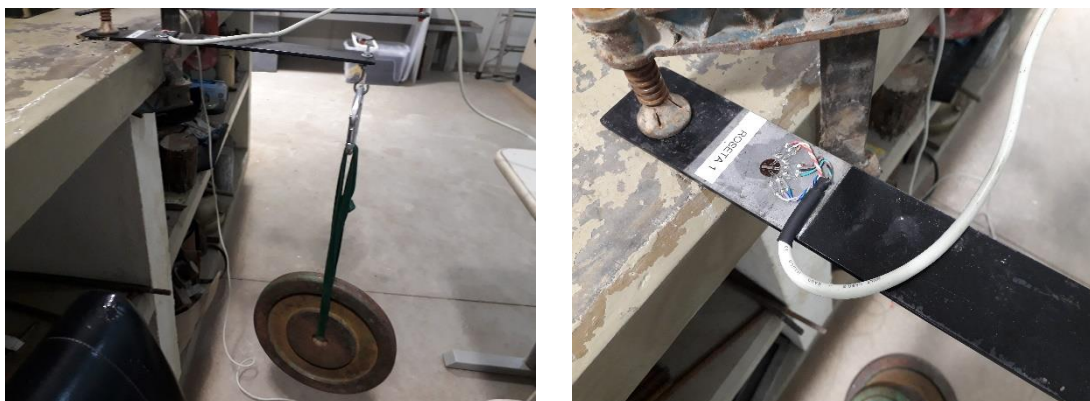
Figura 115. Lâmina metálica com extensômetro tipo roseta
