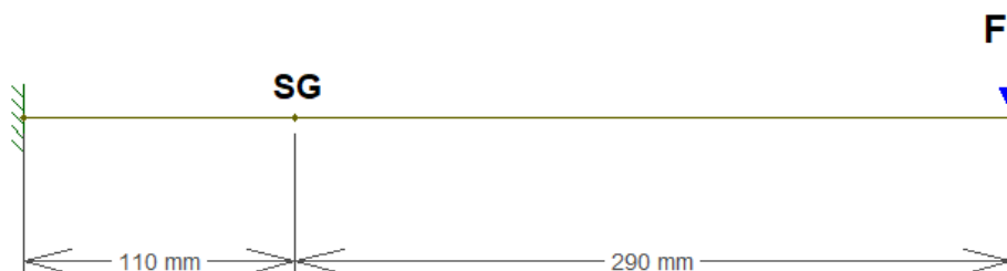
Figura 95. Lâmina n.º 2 com extensômetro (SG) tipo roseta
