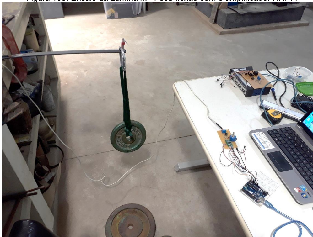
Figura 109. Ensaio da Lâmina n.º 1 sob flexão com o amplificador HX711
