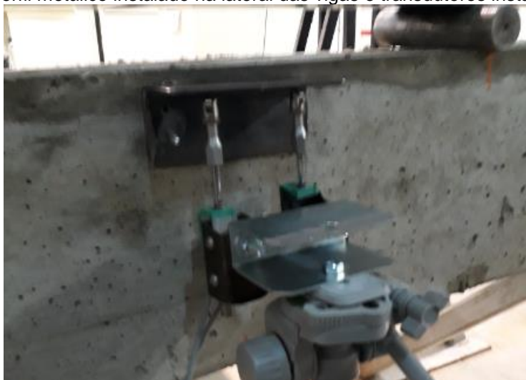
Figura 130. Perfil metálico instalado na lateral das vigas e transdutores instalados em tripé
