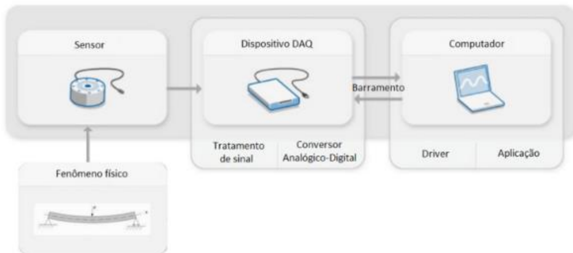
Figura 50. Esquema típico de um sistema de monitoramento computadorizado
