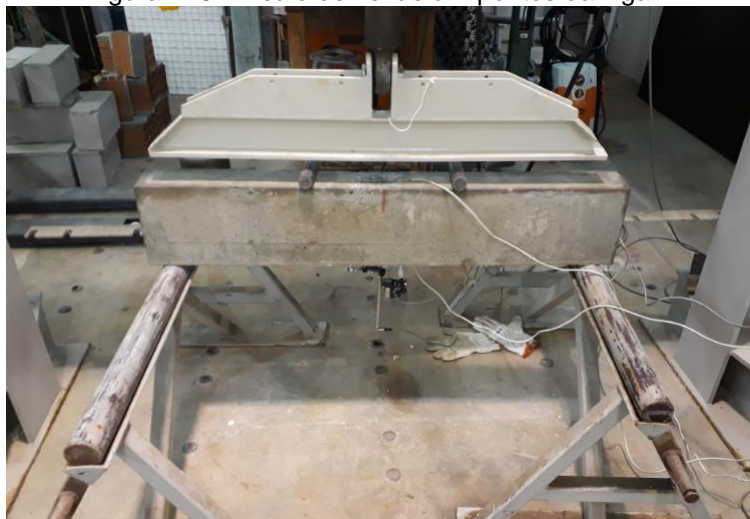
Figura 126. Ensaio de flexão à 4 pontos da viga T1
