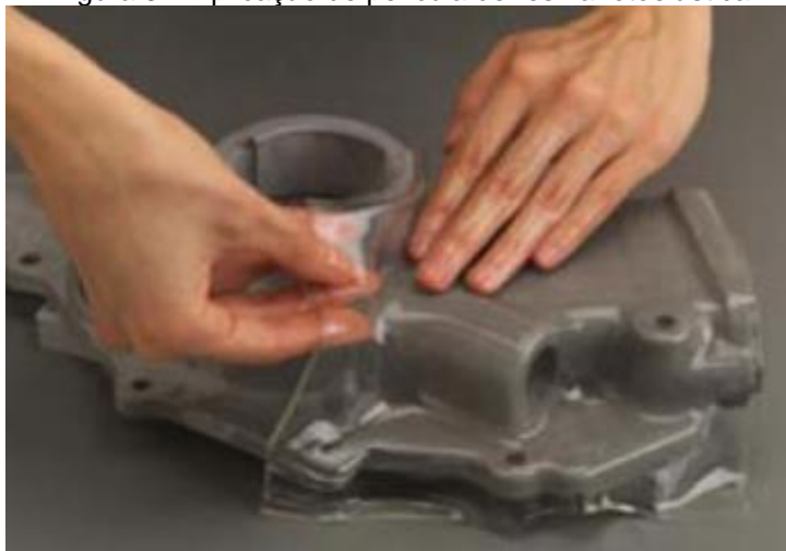
Figura 34. Aplicação de película de resina fotoelástica
