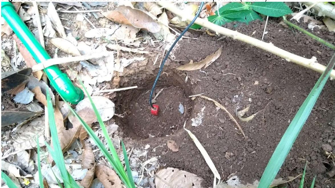
**Figura 33** – Sensor de umidade do solo *VH400* instalado (Área 1).
