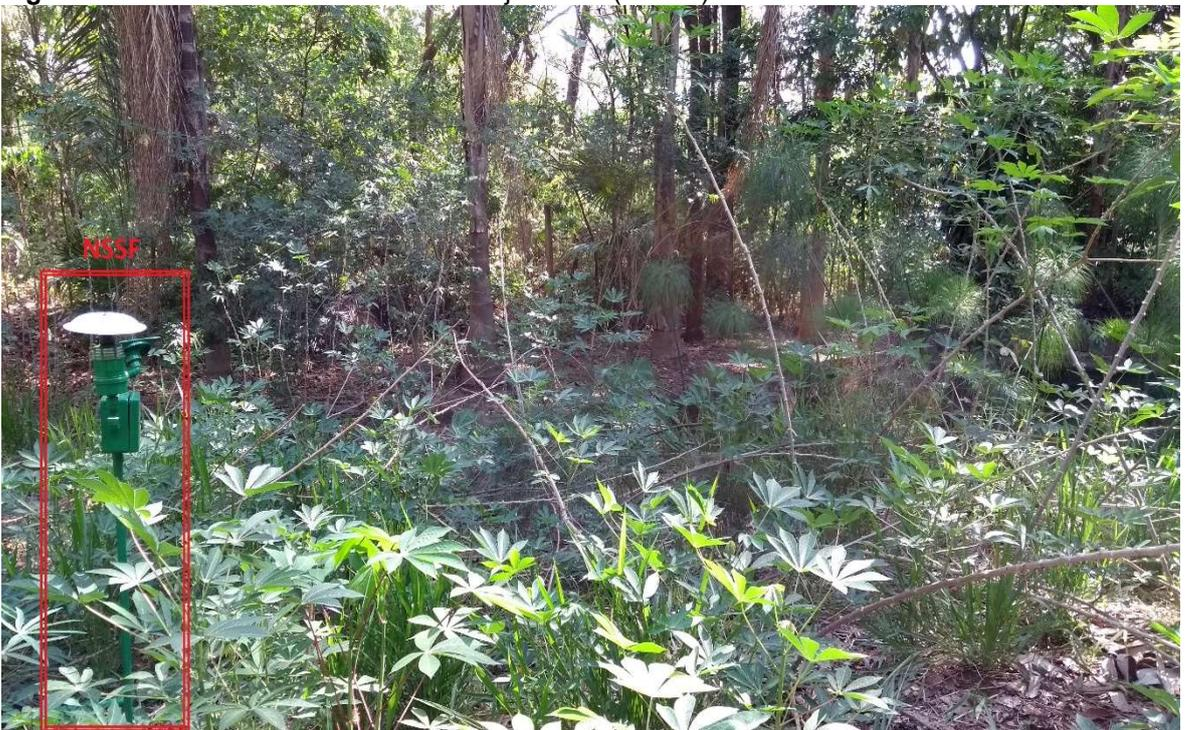
**Figura 32** – Sensor de umidade do solo *VH400* à 18 cm da superfície (Área 1).
