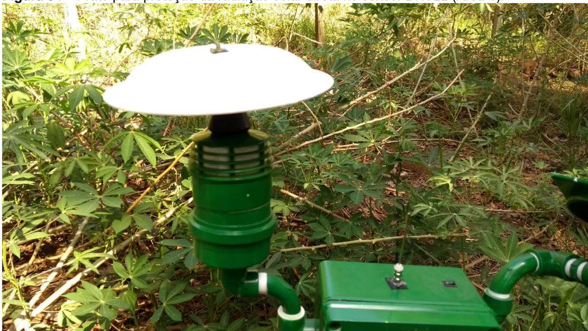
Após 2 dias de testes foi constatada através dos valores de *RSSID* e *RSSIU*, uma diminuição na intensidade do sinal. Foi verificado no local que a estrutura que sustentava o NSSF havia cedido, fato ocorrido devido aos fortes ventos ou impacto de algum animal silvestre. Com a queda do NSSF, a antena direcional perdeu parte de seu alinhamento com a estação base, resultando em uma atenuação de sinal na transmissão.
