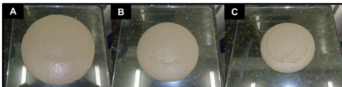
Figura 40 – Aspecto visual do espalhamento da argamassa ARG-REF: (a) aos 5 minutos; (b) aos 30 minutos; (c) aos 60 minutos;
