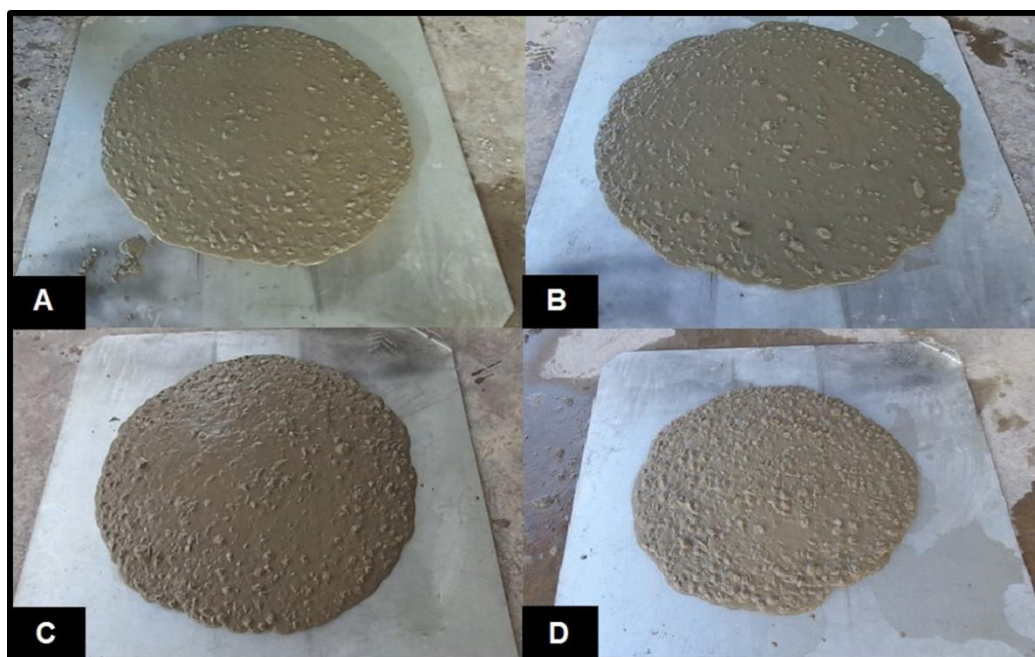
Figura 47 – Espalhamento dos concretos: (a) CAA-REF; (b) CAA-AGR; (c) CAA-AMR e (d) CAA-AGMR.
