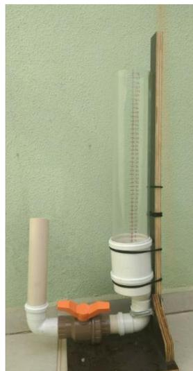
O coeficiente de permeabilidade é obtido através da leitura da altura inicial e final do reservatório e do tempo utilizado para a infiltração. Para o cálculo do mesmo, utiliza-se a equação 2.
