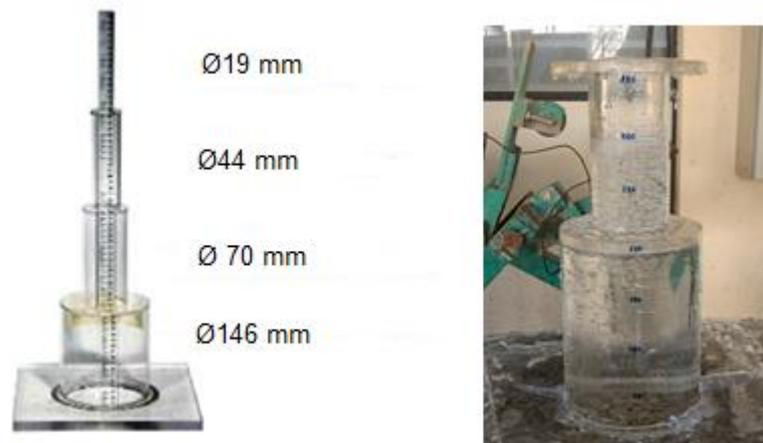
A fórmula utilizada para o cálculo do coeficiente de permeabilidade, neste caso, avalia a diferença de nível de água em relação ao tempo gasto para a infiltração da água e os diâmetros dos tubos. Portanto se assemelha ao ensaio executado com o permeômetro de carga variável realizado em laboratório.
