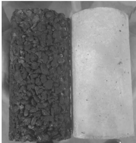
Devido a sua estrutura porosa, existe uma diferença entre os tempos de chegada e reflexão das ondas sonoras relativas a movimentação dos veículos sob o pavimento. Essa diferença resulta na diminuição da intensidade do ruído gerado pelo tráfego (OLEK *et al.*, 2003 apud Batezini, 2013).
