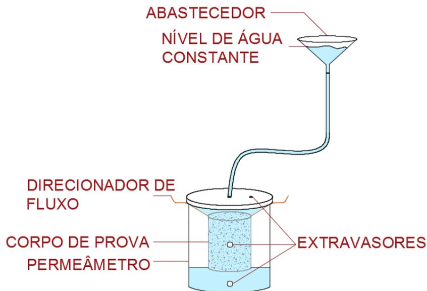
Para garantir o sucesso na realização do mesmo, é necessário saturar o corpo de prova, verificando a presença de água através dos extravasores e empregar um direcionador de fluxo, bem como vedar a lateral do corpo de prova para que não ocorram vazamentos.
