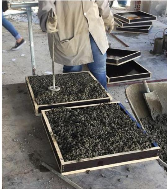
Após moldadas, as placas foram inseridas na câmara úmida e permaneceram em nos moldes até completarem a idade de 28 dias para serem submetidas aos ensaios de estudo da colmatação.
