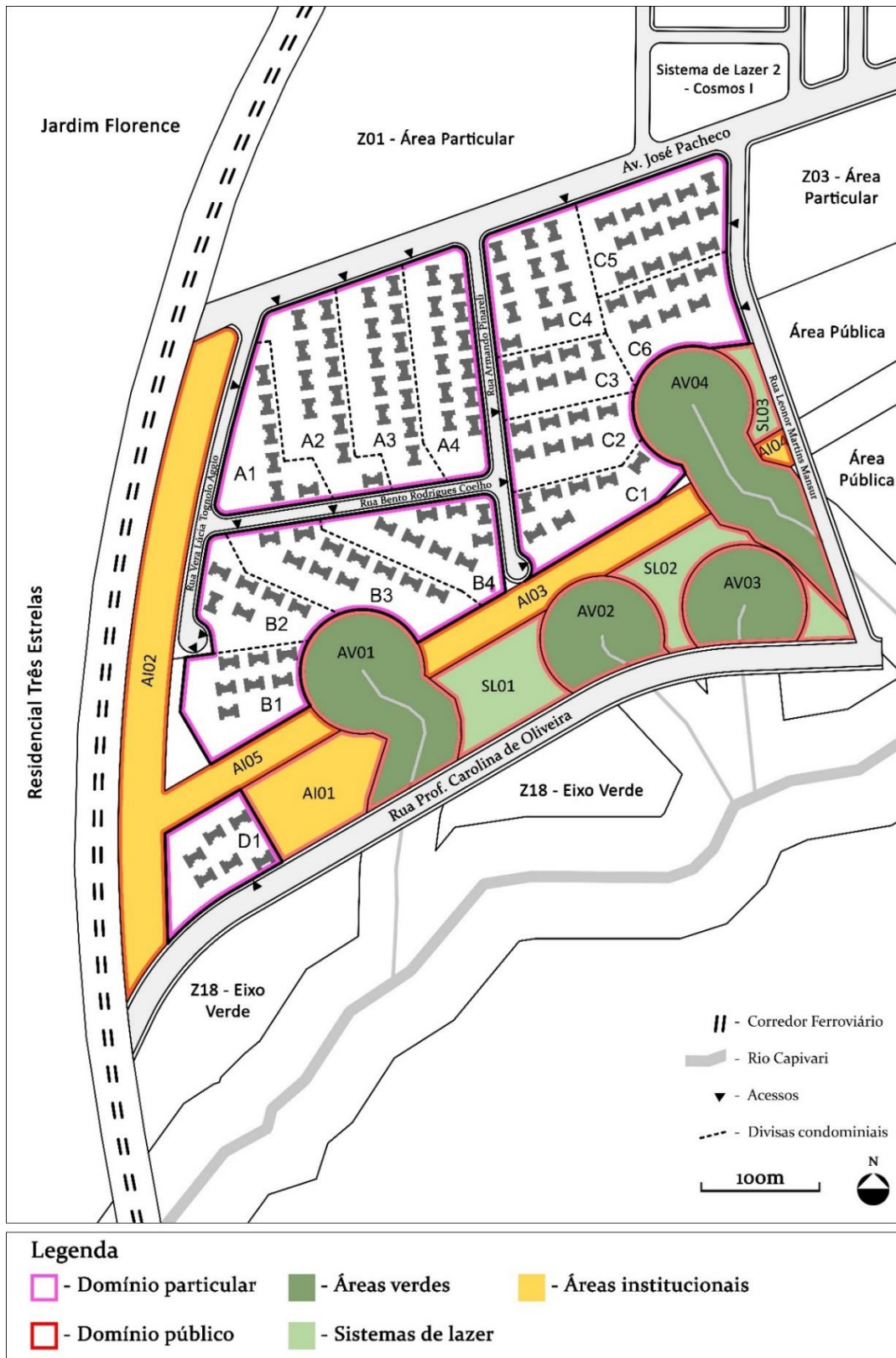
Figura 18 - Planta simplificada do Residencial Sirius com destaque para o parcelamento do solo. Elaboração do autor, 2017
