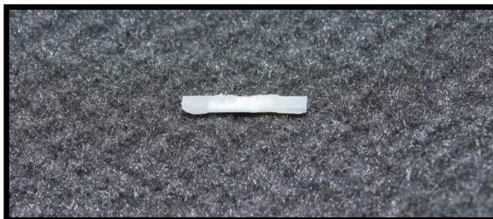
Previamente ao ensaio de microtração, a largura e espessura de cada corpo de prova foram mensurados com paquímetro digital (Mitutoyo, Suzano, Brasil) (Figura 15) com precisão de 0,01 mm. Em cada grupo foram obtidos 44 palitos.
