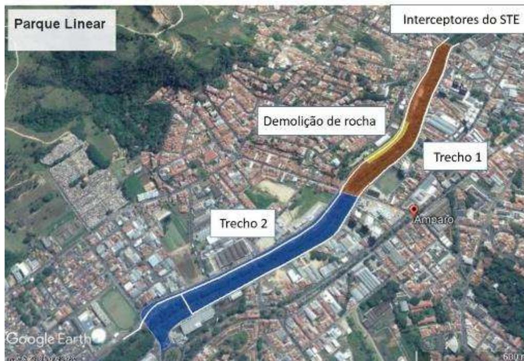
Figura 82: Imagem com o desenho esquemático dos Trechos 1 e 2, que iniciaram as obras do Parque Linear, com o traçado dos interceptores do Sistema de Tratamento de Esgotos e a área em que ocorreu a demolição das rochas para a passagem do interceptor na avenida Doutor Carlos Burgos sobreposta à imagem de satélite. Google Earth 2018.
