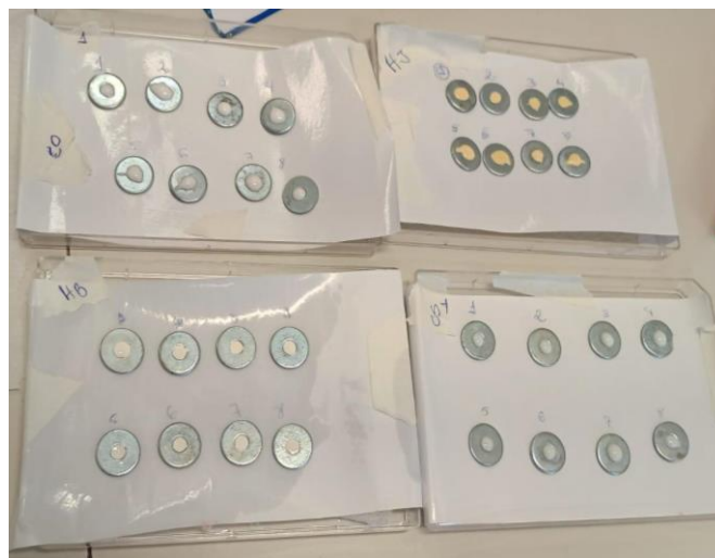
Figura 7: Cimentos Inseridos nas Arruelas
