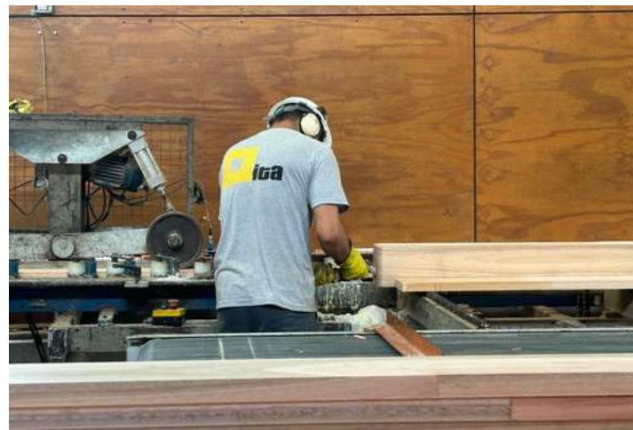
Corte dos "dentes" para encaixe
