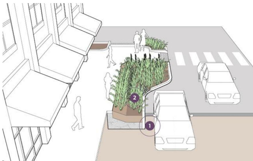
Figura 68 - Imagem gráfica de exemplo de canteiro pluvial. Fonte: NACTO, s.d.c, p. 1.
