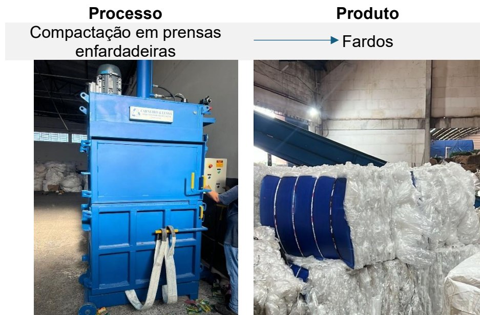
Figura 14 – Compactação de plásticos
