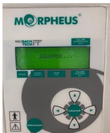
Figura 12 – Após o acionamento da tecla preparar a mensagem aguarde ficará exposta no Display, enquanto o equipamento se prepara para disponibilizar a técnica TASA pediátrica. (Fonte: Autoria própria, 2025)
