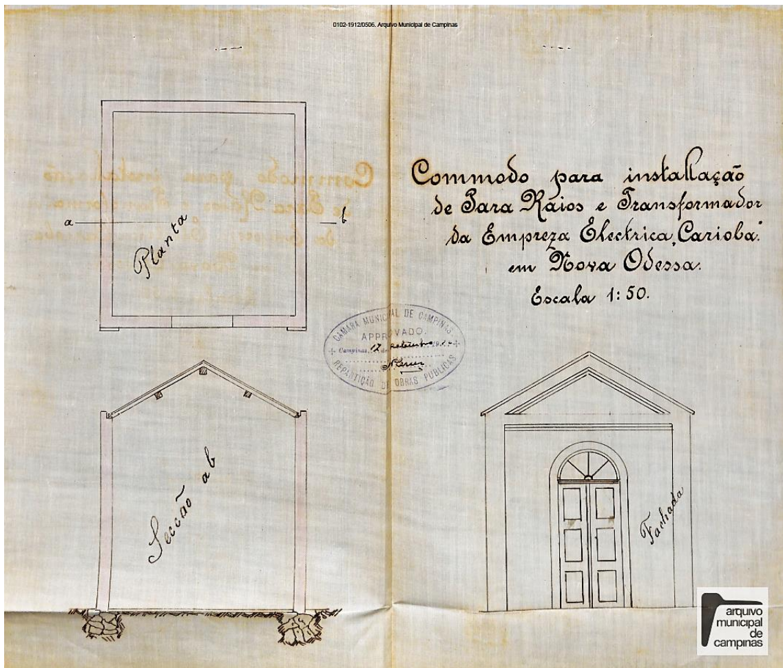
Figura 31. Projeto do cômodo para a instalação de para-raios e transformadores na empresa Elétrica Carioba Rawlinson Müller e Companhia, Nova Odessa, Villa Americana. Processo 1912/506.
