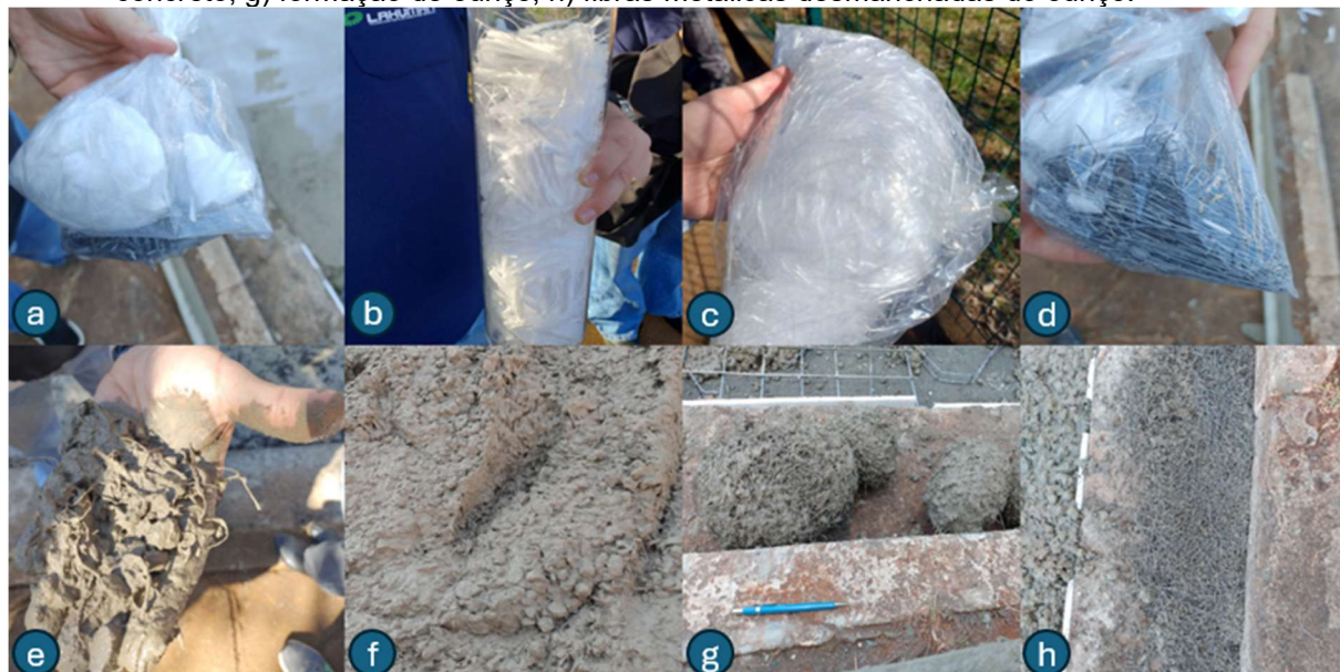
Figura 27: Fibras, sendo: a) microfibra polimérica, b e c) macrofibras poliméricas, d) macrofibras metálicas, e) composição macrofibra polimérica e concreto, f) composição macrofibra metálica e concreto, g) formação de ouriço, h) fibras metálicas desmanchadas do ouriço.
