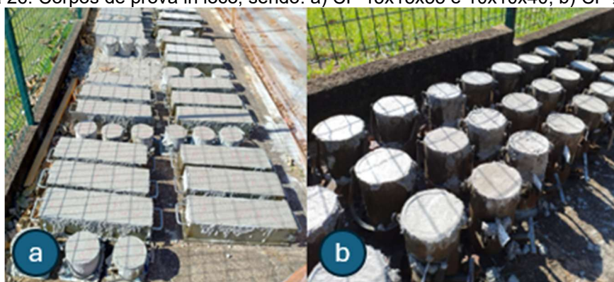
Figura 26: Corpos de prova in loco, sendo: a) CP 15x15x55 e 10x10x40, b) CP Ø10x20
