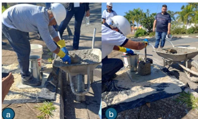
Figura 25: Ensaios de ar incorporado e grau de abatimento, sendo: a) início do ensaio de slump, b) aferição do ensaio de slump.
