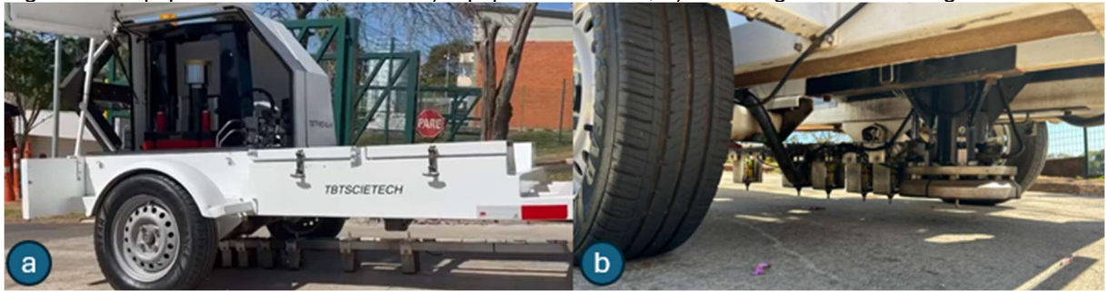
Figura 42: Equipamento FWD, sendo: a) equipamento FWD; b) disco e geofones/sismógrafos
