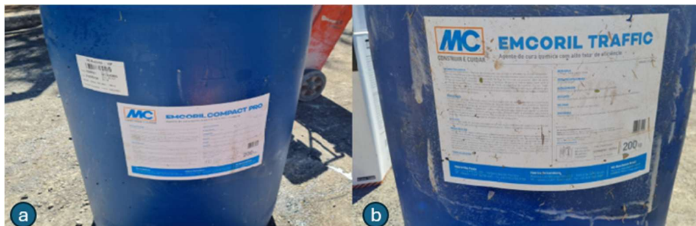
Figura 32: Agentes de curas aplicados, sendo: a) cura intermediária, b) cura final
