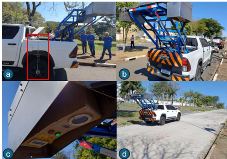
Figura 39: RSP MK-IV e perfilômetros inerciais, sendo: a) sensor de nível nas rodas para avaliar do veículo, b) sensores para escaneamento, c) escâner, d) passagem do veículo na pista para coleta dos dados
