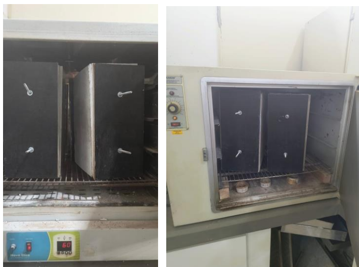
Figura 49 – Protótipos na estufa a 60°C.
