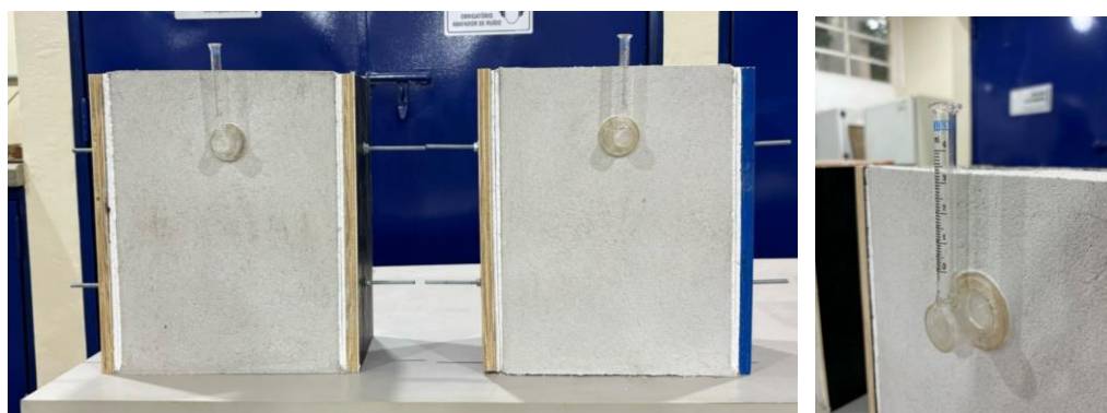
Figura 45 – Ensaio do cachimbo nos protótipos
