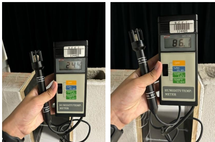
Figura 53 – Equipamento utilizado para aferir a temperatura ambiente e a umidade relativa do ar.
