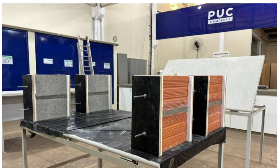
Figura 33 – Registro fotográfico dos quatro prismas antes da aplicação das camadas de revestimento.
