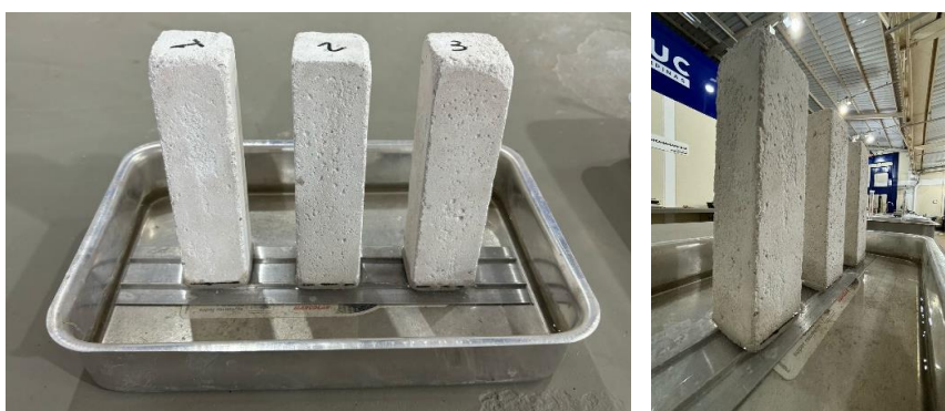
Figura 47 – Ensaio de determinação da absorção de água por capilaridade
