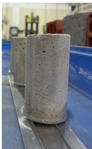
Figura 46 – Lâmina constante de 5 mm durante o ensaio de absorção por capilaridade de corpos de prova cilíndricos
