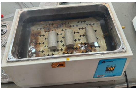
Figura 41 – Corpos de prova utilizados nos ensaios de absorção de água dentro do banho maria para imersão em água em ebulição por 5h.
