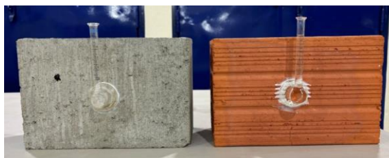
Figura 44 – Ensaio do cachimbo nos blocos cerâmico e de concreto
