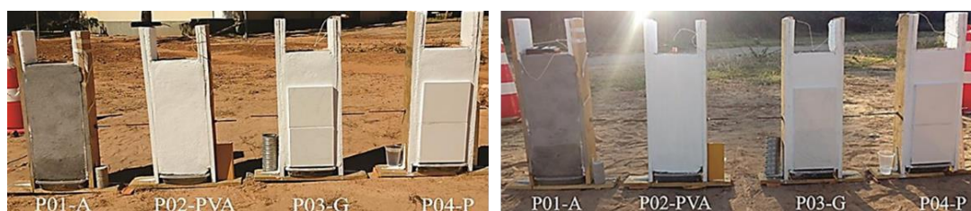
Figura 20 – Imagem digital dos protótipos argamassado (a), com pintura (b), revestimento grés (c) e porcelanato (d) em ambiente com incidência solar (esquerda) e sem incidência solar (direita).
