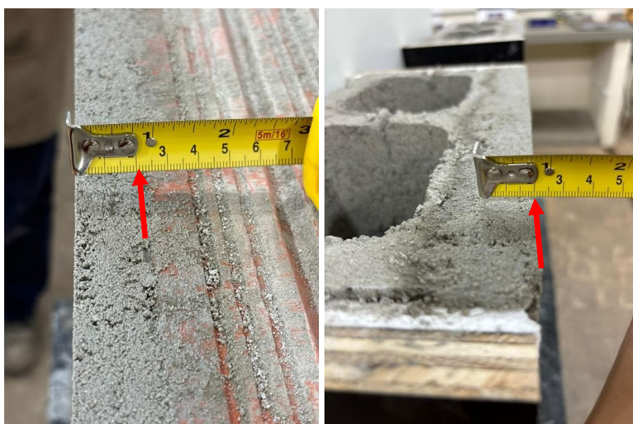
Figura 37 - Registro fotográfico da espessura do revestimento argamassado de 2 cm no prisma de bloco cerâmico à esquerda e de bloco de concreto à direita.
