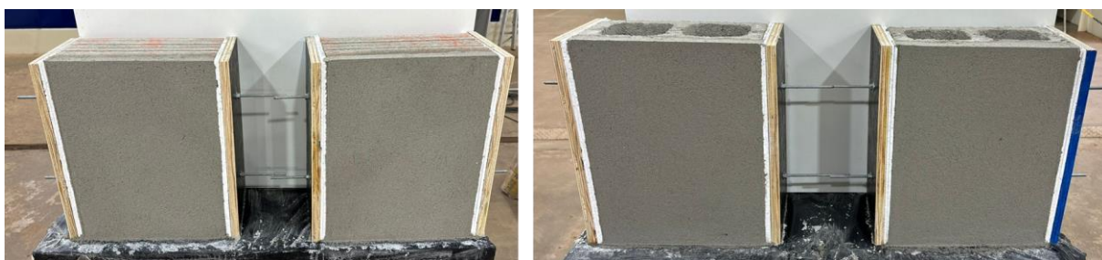
Figura 35 - Registro fotográfico dos quatro prismas com massa única, sendo os dois à esquerda de bloco cerâmico e os dois à direita de bloco de concreto.
