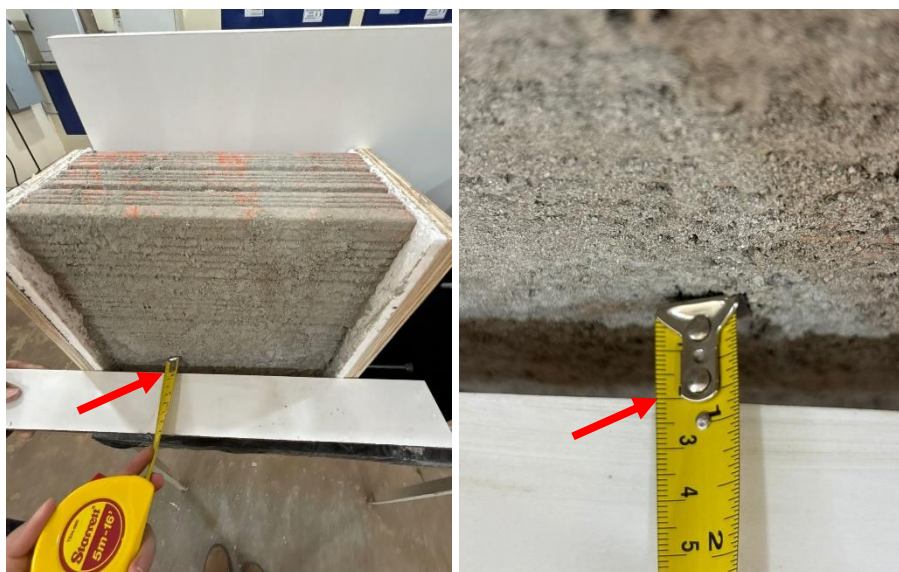
Figura 36 – Registro fotográfico da espessura do revestimento argamassado de 2 cm no centro do prisma de bloco cerâmico.
