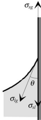
Figura 2 - Balanço de forças resultante no contato do menisco ( \sigma_{sl} = tensão superficial entre o sólido e o líquido; \sigma_{sg} = tensão superficial entre o sólido e gás; \sigma_{lg} = tensão superficial entre o líquido e o gás ( \sigma_{lg} ))
