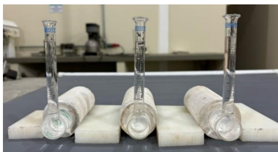
Figura 43 – Ensaio do cachimbo nos corpos de prova de argamassa
