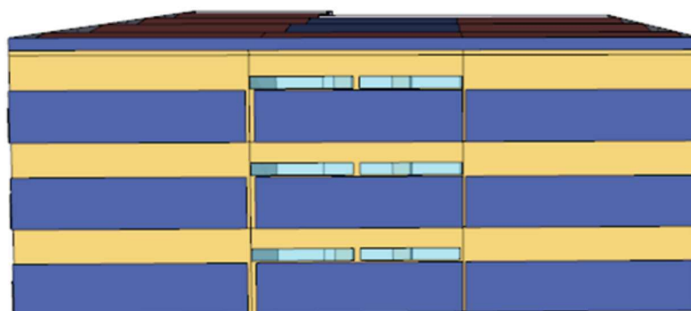
Figura 46. Implementação de Fachada Fotovoltaica no Modelo F4-BIPV.
