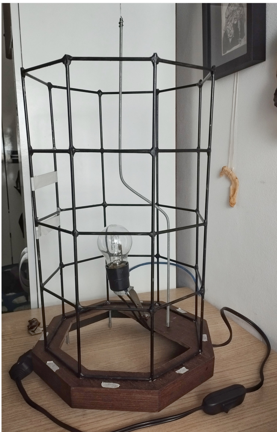
Figura 19: Base após a conexão do fio no soquete, montagem e pintura da estrutura externa (feita com varetas de aço galvanizado e massa epoxi nas junções).
