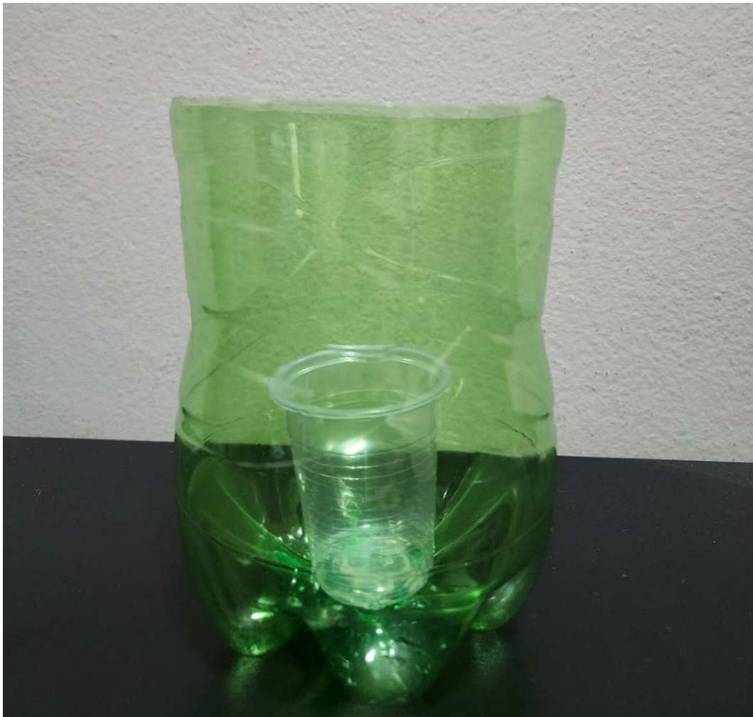
Figura 3. Armadilha modelo pitfall .
