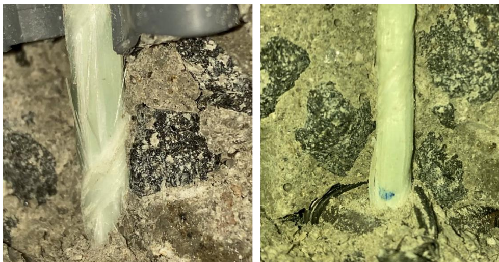
Figura 58: Ruptura da armadura após ensaio de flexão
