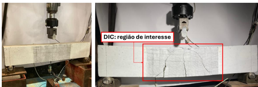
Figura 40: Ensaio de flexão à três pontos e região de interesse do DIC
