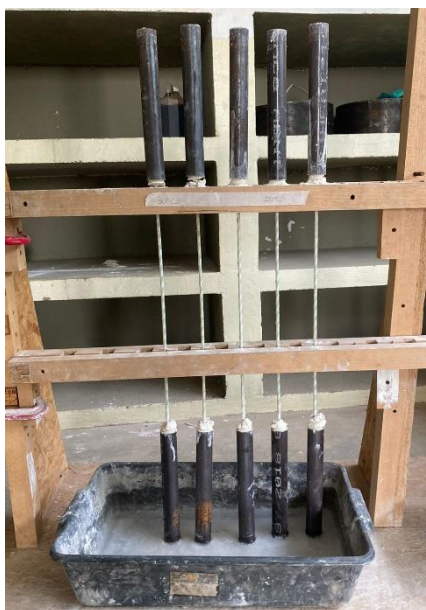
Figura 28: Ancoragem das barras de GFRP em aparato de madeira
