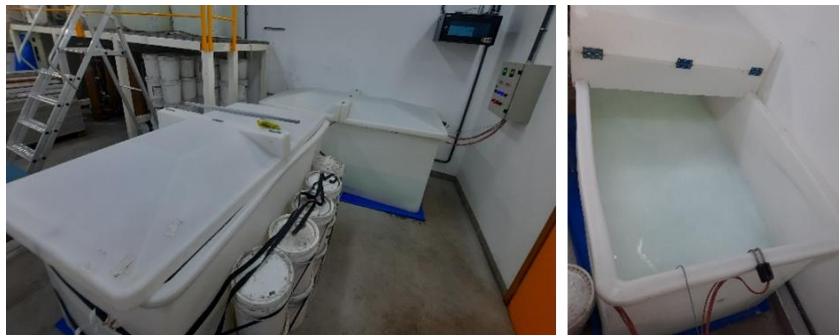
Figura 38: Tanques de imersão, configuração de ensaio e solução alcalina
