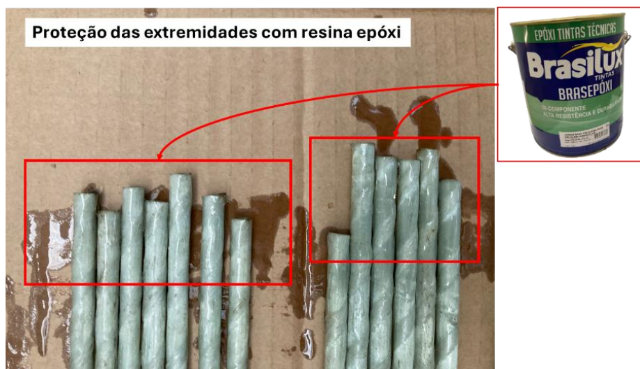
Figura 34: Proteção das extremidades das barras com resina epóxi
