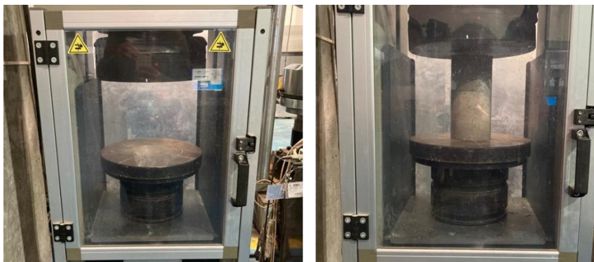
Figura 20: Corpo de prova em ensaio de compressão simples
