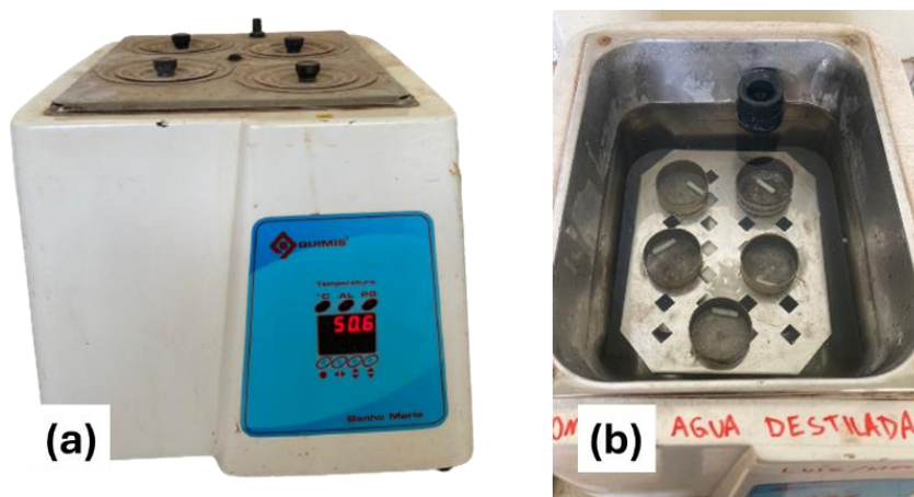
Figura 33: Ensaio de absorção (a) equipamento termostático e (b) corpos de prova
