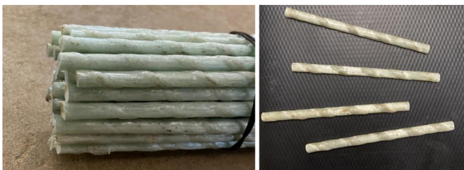
Figura 26: Enrolamento helicoidal na superfície das barras de GFRP
