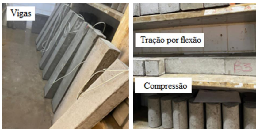
Figura 25: Processo de cura das amostras concretadas
