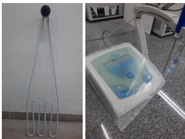
Figura 37: Resistência e equipamento para medição do pH da solução
