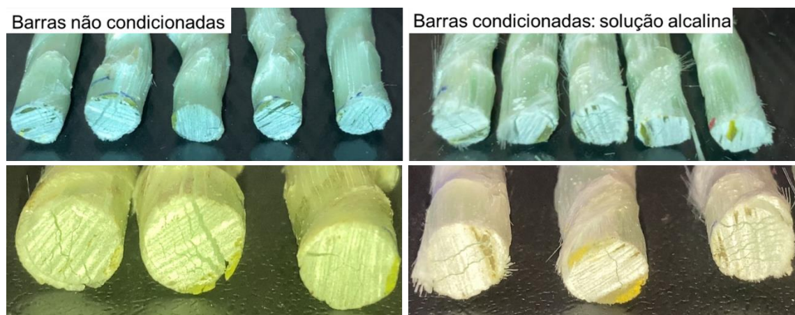
Figura 46: Modo de falha devido ao cisalhamento longitudinal
