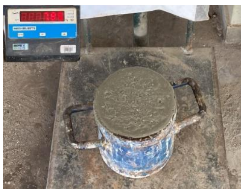
Figura 14: Molde padrão utilizado para definir a massa específica do concreto
