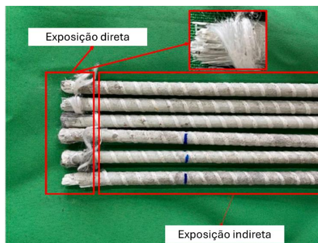
Figura 8: Efeito do ambiente alcalino nas barras de GFRP
