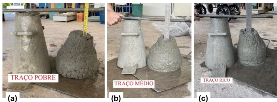
Figura 13: Abatimento de tronco de cone: traço (a) pobre, (b) médio e (c) rico
