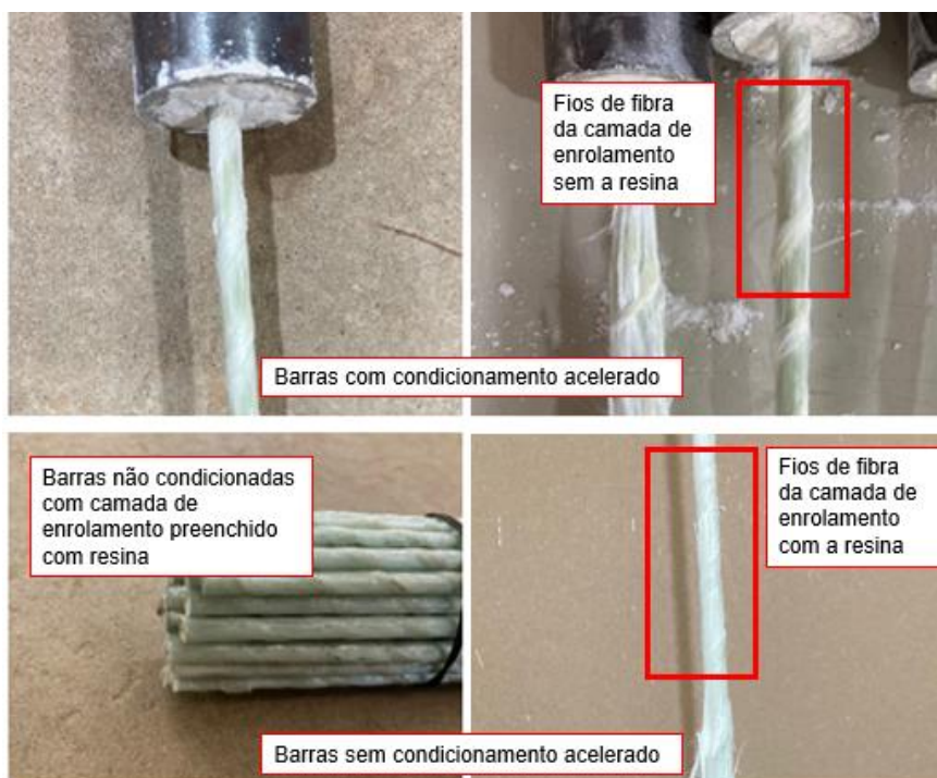
Figura 51: Perda da resina nas camadas de enrolamento da barra e alteração de cor
