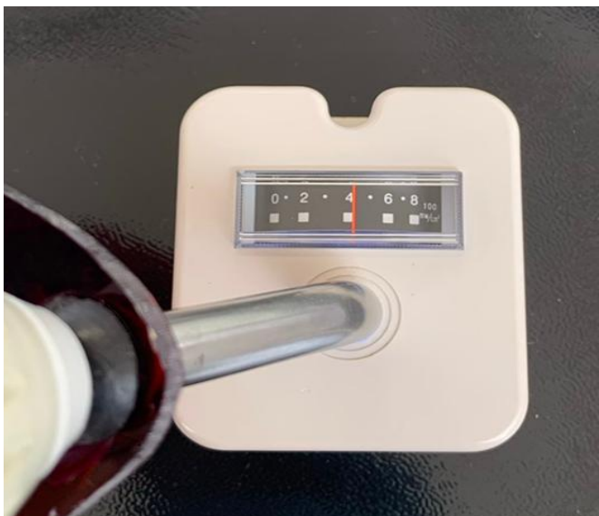
Figura 3. Medição da Potência Aparelho Fotopolimerizador QTH Esc.
