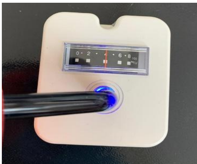
Figura 2. Medição da Potência Aparelho Fotopolimerizador LED Pul e LED Ramp.
