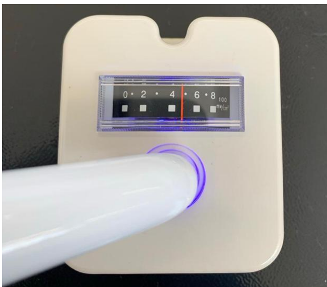
Figura 2. Medição da Potência Aparelho Fotopolimerizador LED Pul e LED Ramp.
