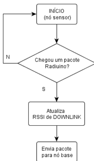
Figura 13 - Algoritmo de funcionamento do nó sensor utilizado para a aquisição do RSSI.
