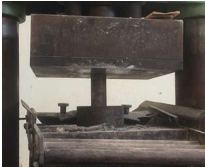
Figura 25 - Copos de provas sendo ensaiados em prensa hidráulica
