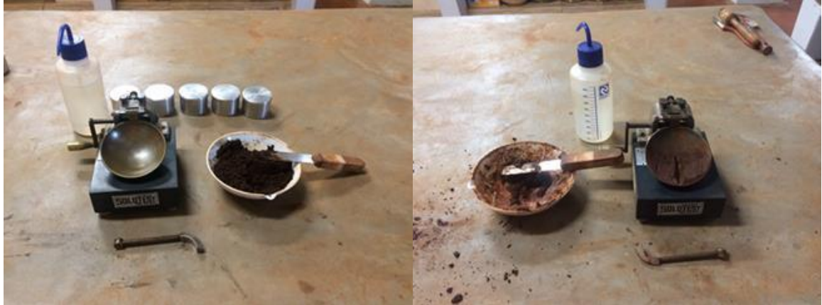
Figura 16 - Aparelho de Casagrande e o solo sendo ensaiado.
