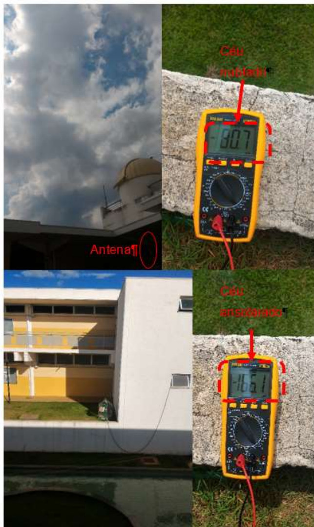
Figura 40 – Corrente com o tempo nublado e ensolarado
