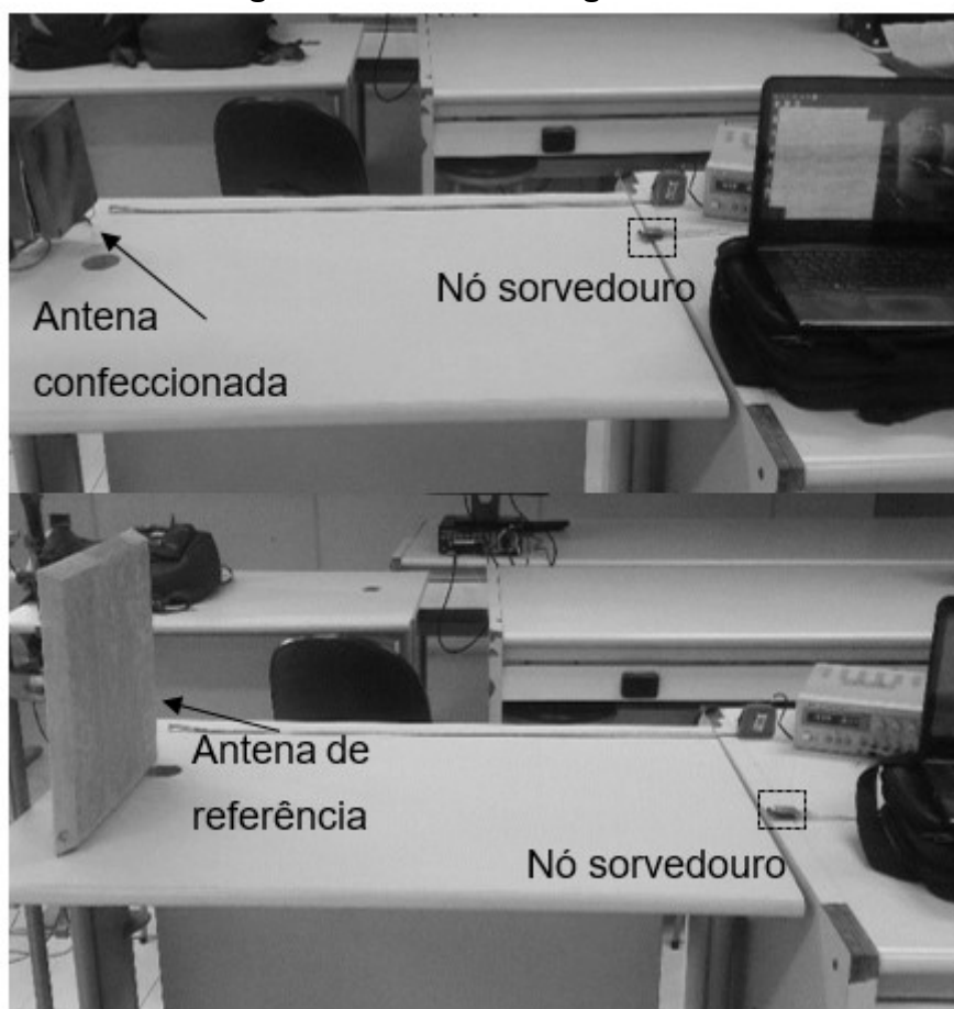
Figura 37 – Teste de ganho da antena
