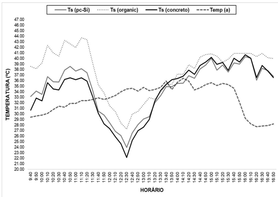
Figura 52 – Comportamento da T_s nos blocos de concreto com o sistema BIPV no Ensaio I e o comportamento da T_a ao longo do dia do Ensaio I.
