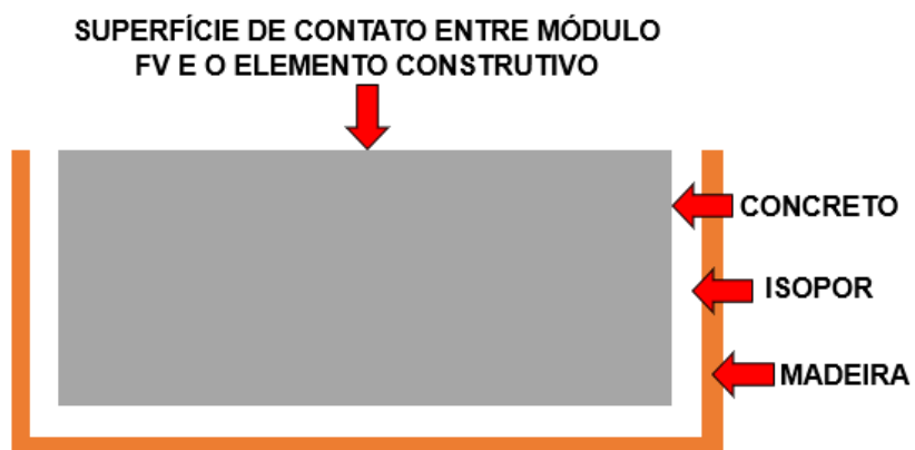
Figura37 – Caixas de isolamento elaboradas para os ensaios dos sistemas BIPVs.
