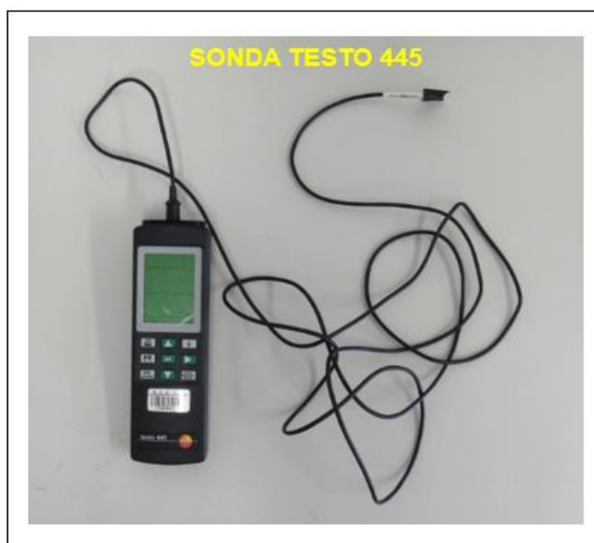
Figura 34 – Sonda de temperatura superficial Testo 445 usada para calibração dos sensores elaborados com o MCP9700A.
