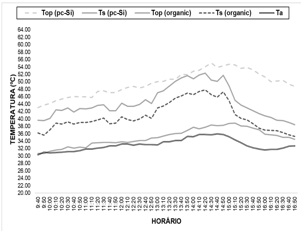
Figura 81 – Comportamento da T_s , T_{OP} e T_a nos sistemas BAPVs coletadas durante o Ensaio VIII.
